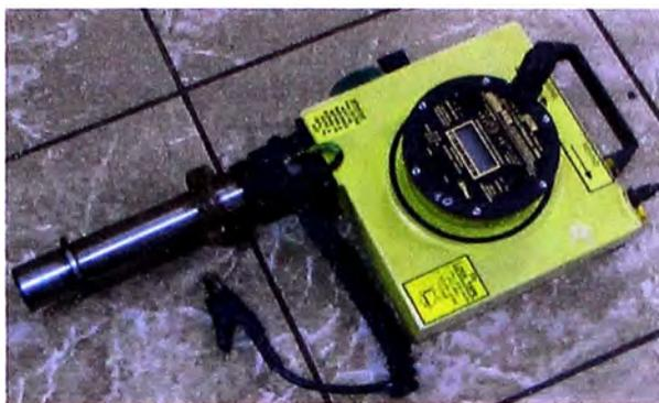
Fig. UTI con Sistema PET para Buques Tanque
