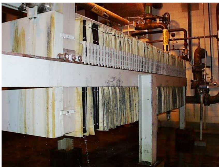
Fig. 1.12: Filtro prensa utilizado para la precipitación del oro en Yanacocha
