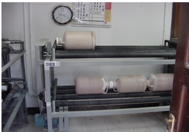
Fig. 5.1: Rodillo para pruebas de cianuración en botellas
