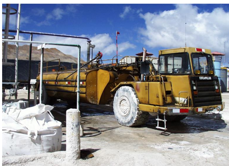
Fig. 1.7: Cisterna de 26 \text{ m}^3 para la adición de lechada de cal en los pads
