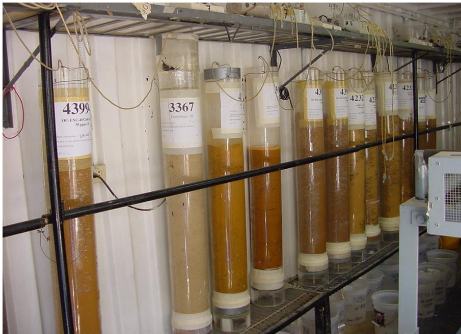
Fig. 5.4: Columnas para pruebas de cianuración (25 Kg de mineral)
