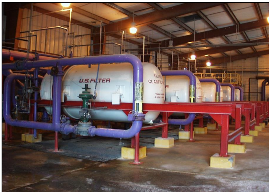
Fig. 1.11: Filtros de clarificación para solución rica en planta YN
