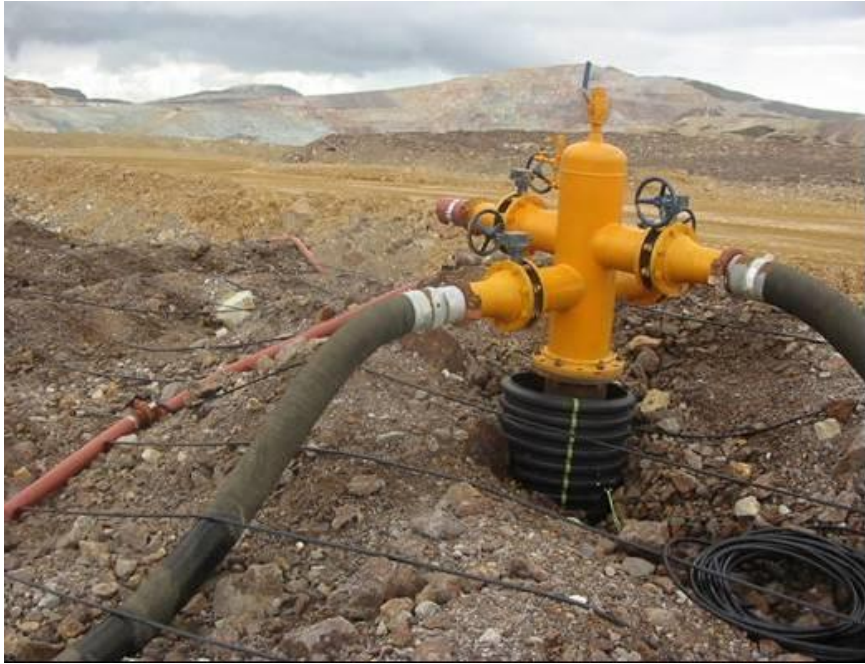
Fig. 4.8: Riser acoplado a un “Christmas Tree”
