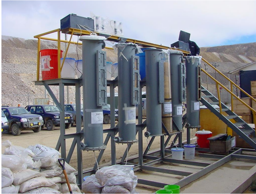
Fig. 5.3: Columnas para pruebas de cianuración (230 Kg de mineral)
