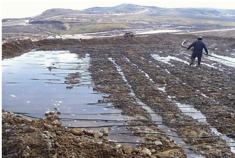
Fig. 4.12: Formación de “pondings” en una celda del pad La Quinoa
