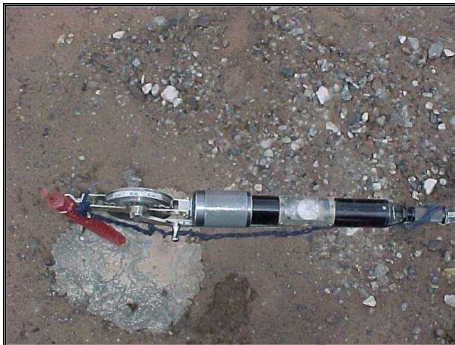
Foto B23 Extensómetro en un punto de control del tajo abierto
