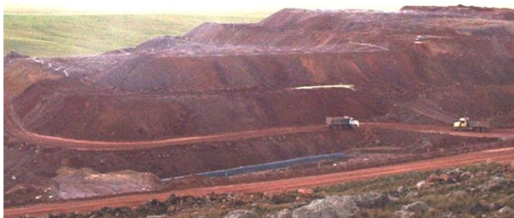
Foto Nro. 22 Carguio del Mineral al Pad
