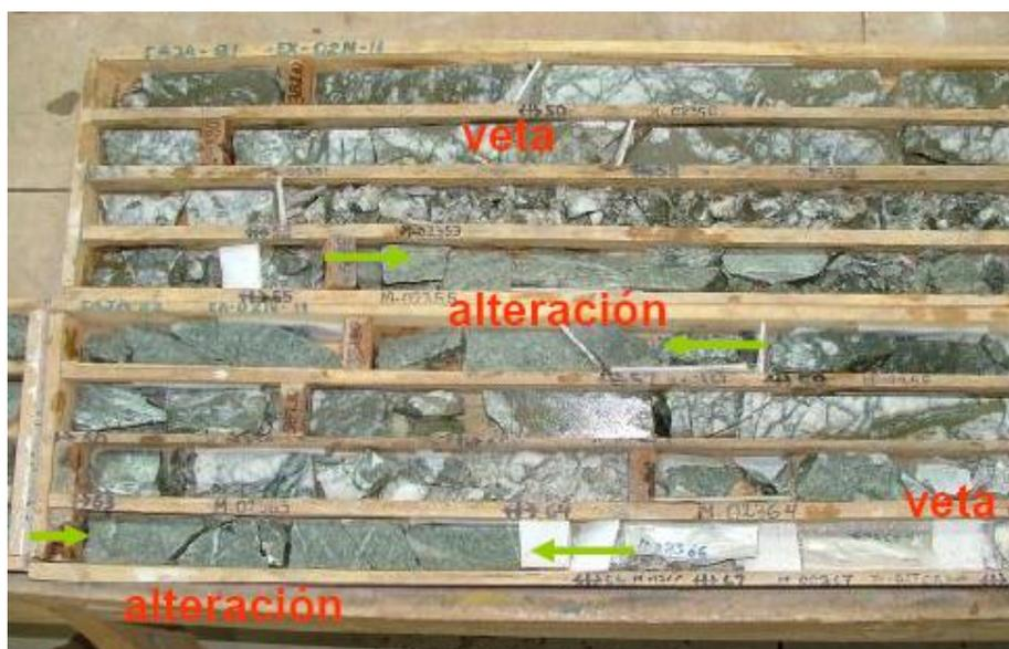
**Grafico N° 6:** Tramos de logueo de testigos y marcado de mineralización y alteración.
