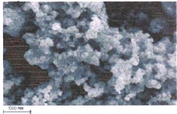
**Fig. 1.10 y 1.11** *Microscopía de Barrido Electrónico (SEM) de partículas de sílice obtenidas con una relación molar de Agua : TEOS : Amoníaco : Etanol (Fig. 1.10) 1 : 4 : 6 :6 (Fig. 1.11) 1 : 4 : 6 : 24, respectivamente*
