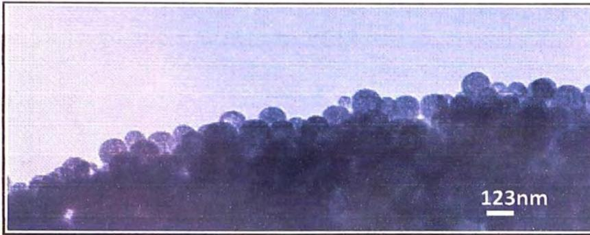
Fig. 3.21 Forma detallada de las nanopartículas de sílice usando PVP 0.3%
