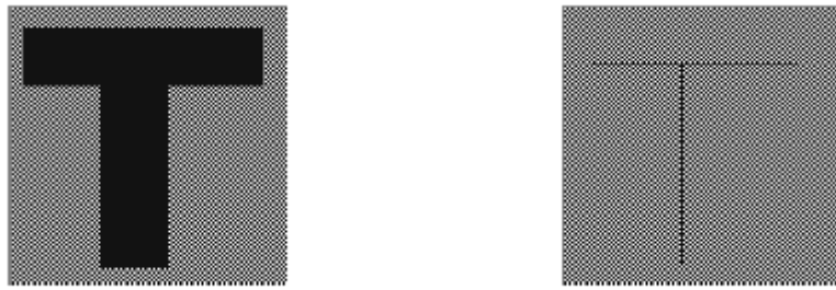
Figura 2.21 Un patrón en forma de T, y su respectivo esqueleto
