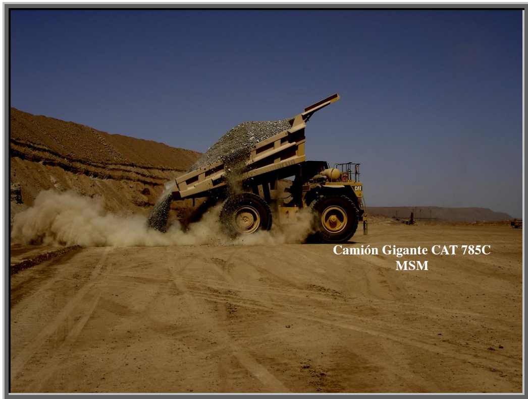
Descarga de material con camiones 785C, durante el proceso de desarrollo
