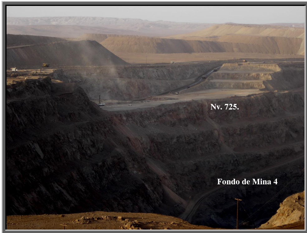
Desarrollo Mina 4 Lado Norte, Rampas de diseño al banco 725
