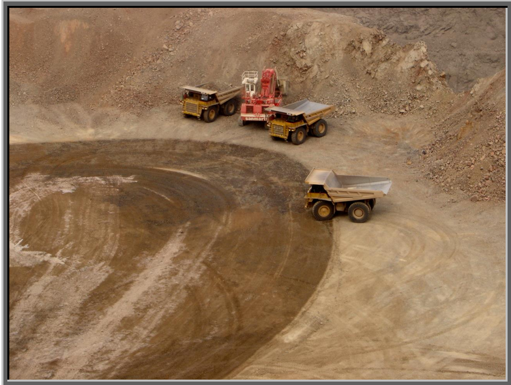
Carguío a ambos lados de la Pala RH90C con camiones CAT 777D
