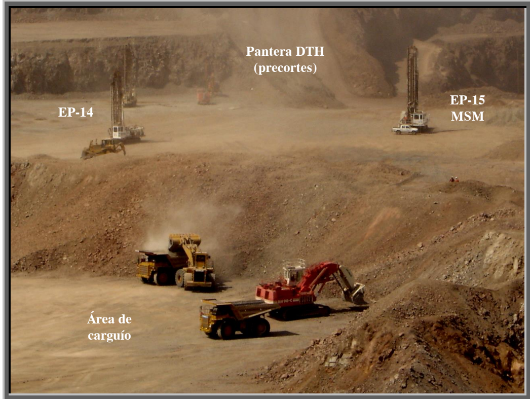
Carguío de desmonte con Pala RH90C y Cargador frontal CAT 992C en el banco 737
