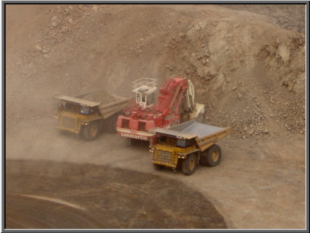
FC 21 y FC 22 durante el carguío a ambos lados de la Pala CH-01
