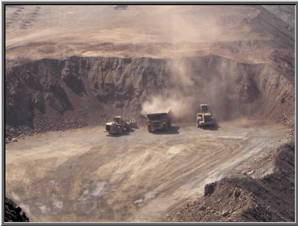
Combinación de carguío entre el Cargador frontal CAT 992C y CAT 998G
