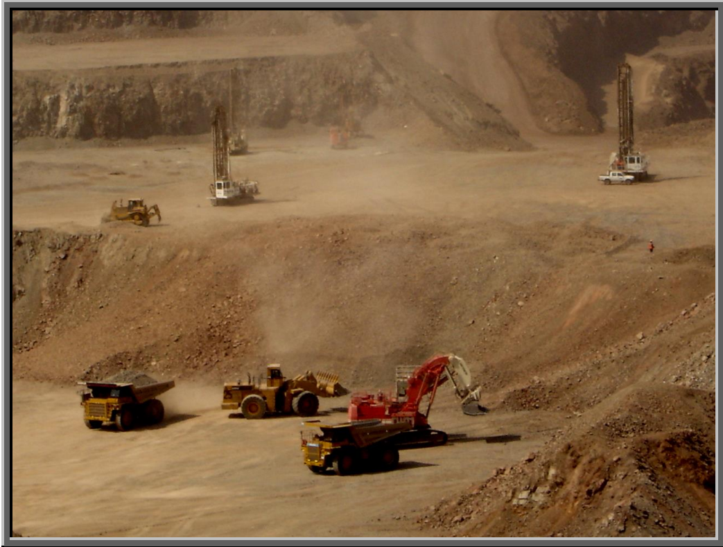
Camiones de acarreo CAT 777D y Komatsu 330 transportando desmote, banco 737
