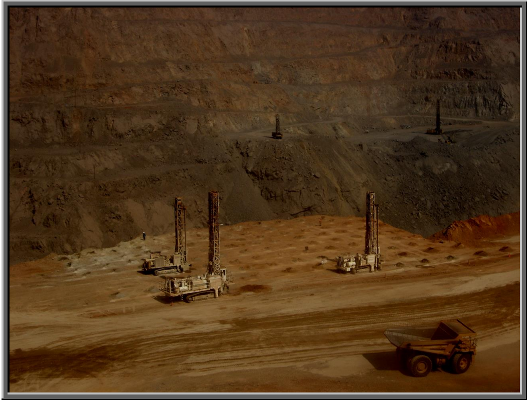
Perforación DrilTech D245S, D75KS e IR modelo DM45S (equipo Alquilado)
