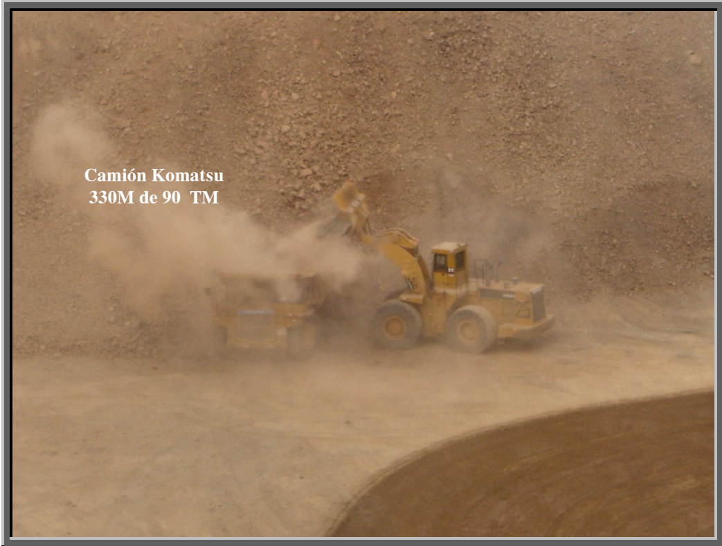
Carguío y acarreo de desmote con Cargador frontal CAT 992C y Komatsu 330M
