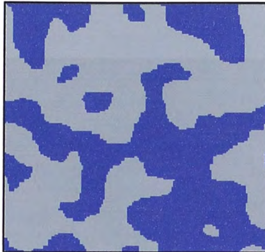
Figura 35: Gráfica de la configuración final para T_5 = 0,1J/k_B(T_5 \ll T_C) cuando la configuración inicial es checkerboard
