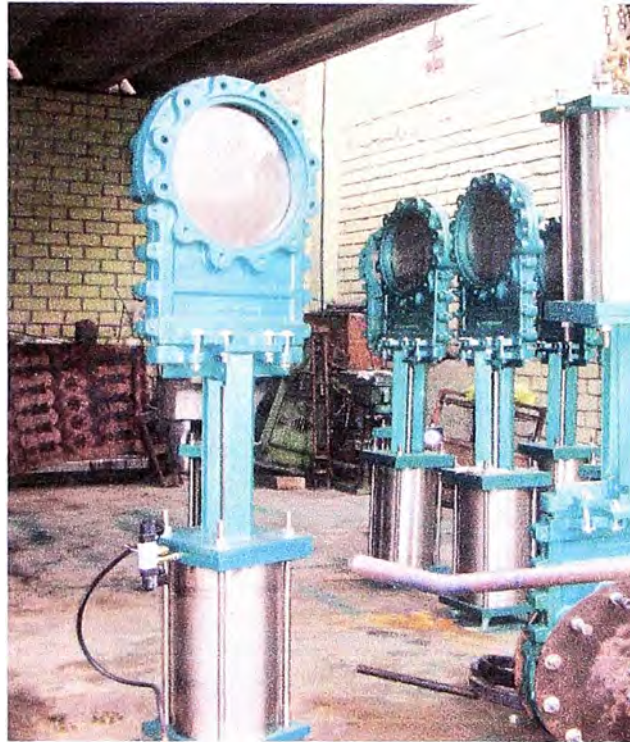
Figura 5.3 La válvula cuchilla Búfalo 1C, el cuerpo es de fierro nodular de una pieza, eje y hoja de acero inoxidable, el accionamiento puede ser manual, neumático o hidráulico.
