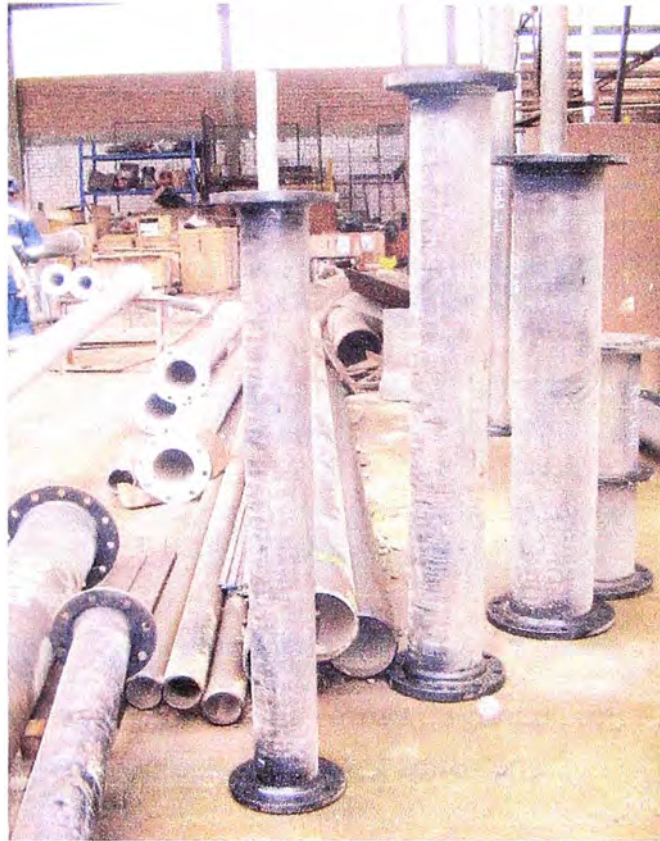
Figura 5.5 Fabricación de niples bridados, los acoples bridados son unidos a las tuberías, el cual después podrán acoplarse entre ellos.
