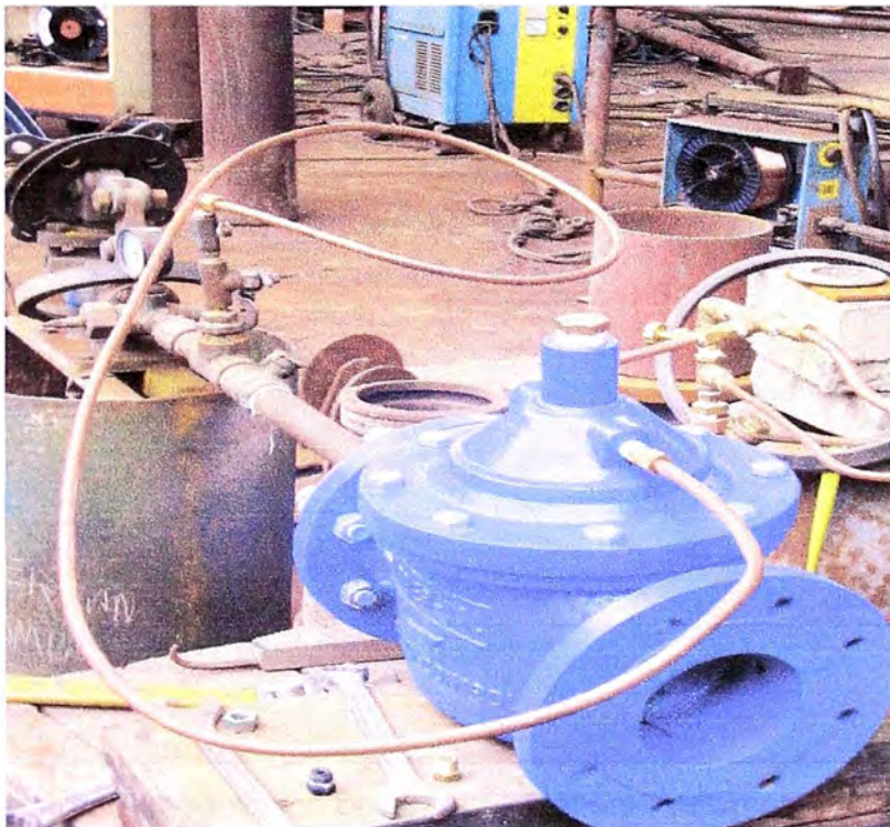
Figura 5.8 Banco de Prueba Hidrostática, esta válvula de control es sometido a presión para detectar fugas y así corregir si fuera el caso.
