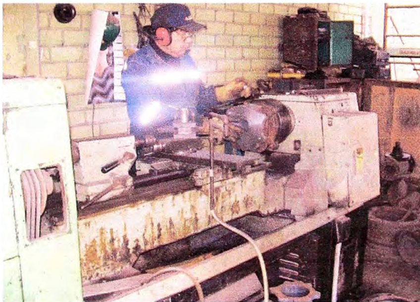
Figura 5.6 Maquinado de accesorios, se hace por personal especializado de acuerdo al plan establecido dentro de la línea de producción.
