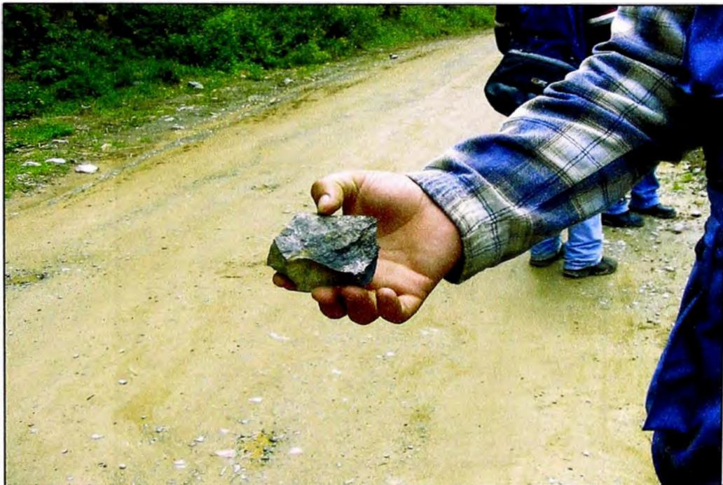
Muestra de roca de la parte inferior del talud. Se identifico como una roca sedimentaria arenisca, grises carbonosos y algo oscuros con alto contenido de pirita.
