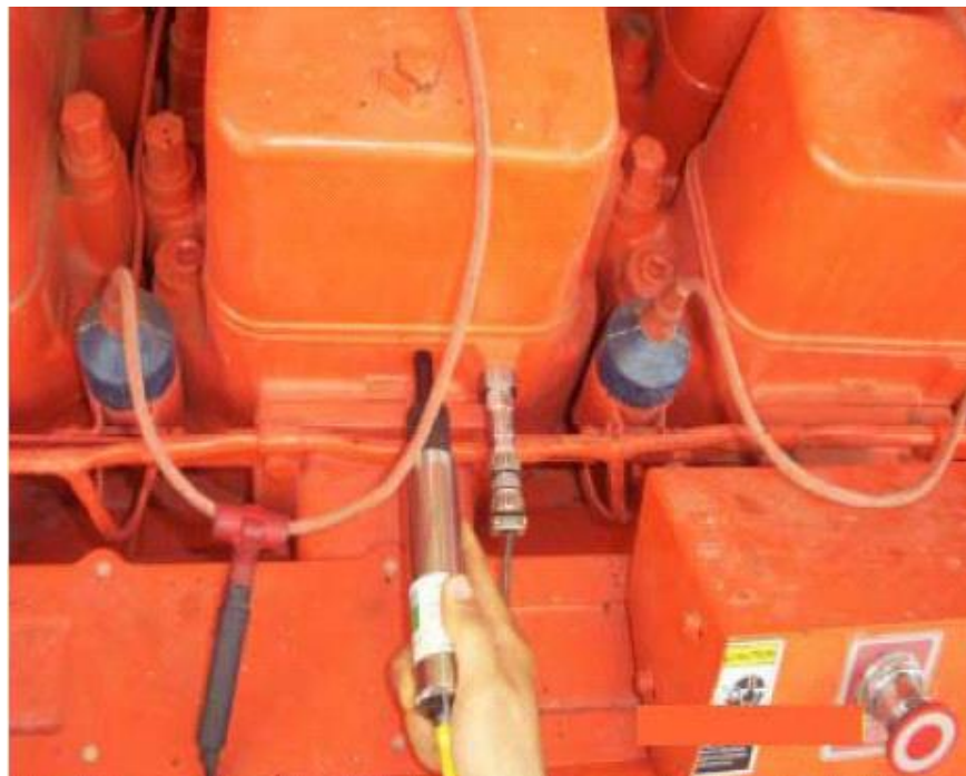
Figura 20. Medición de vibración y ultrasonido en motor WAUKESHA VHP
