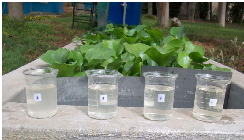
Foto N° 36 Variaciones de turbiedad: (1) Ingreso tanque séptico; (2) Ingreso filtro biológico; (3) Ingreso wetland; (4) Salida wetland
