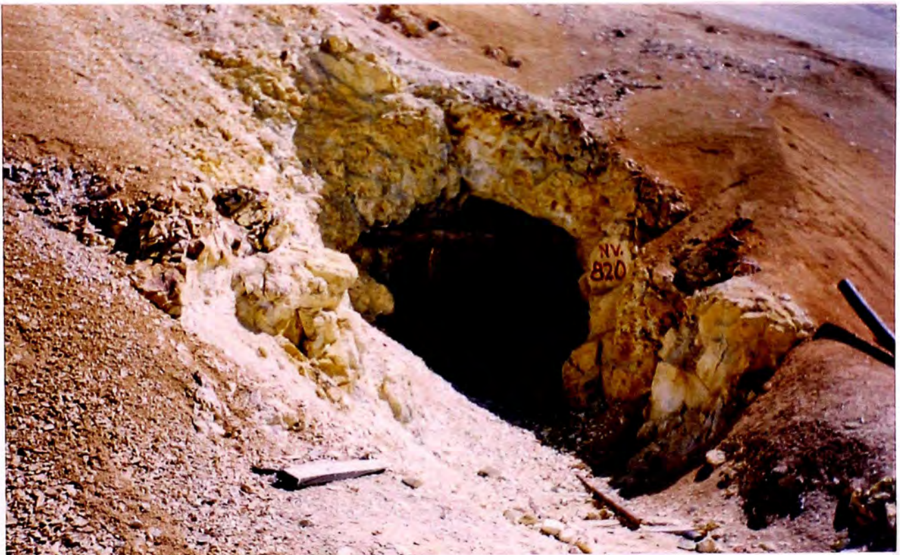
Foto N° 4: Mina El Palomo (Nivel 820), nótese la ausencia de drenaje.
