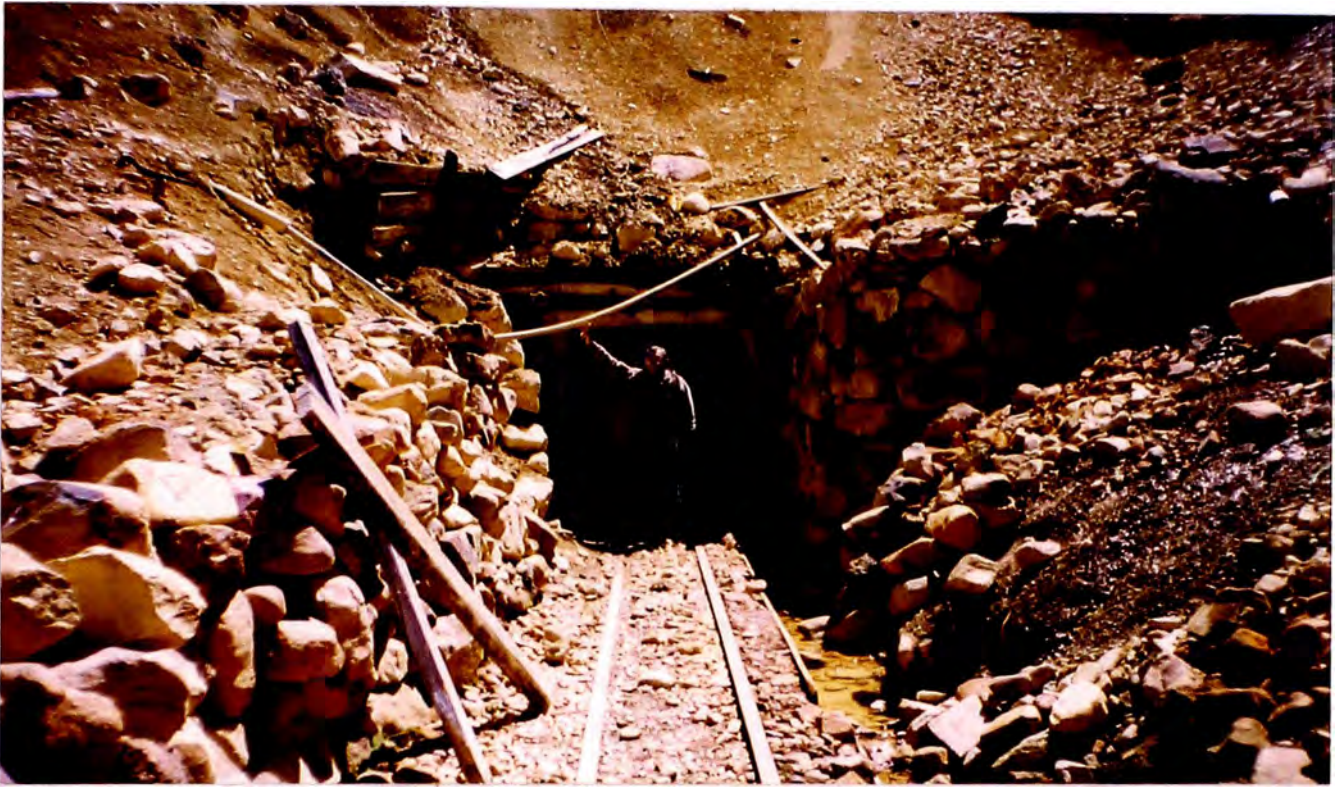
Foto N° 3: Bocamina principal Minal El Palomo (Nivel 720), se observa cuneta con drenaje de agua y rieles.
