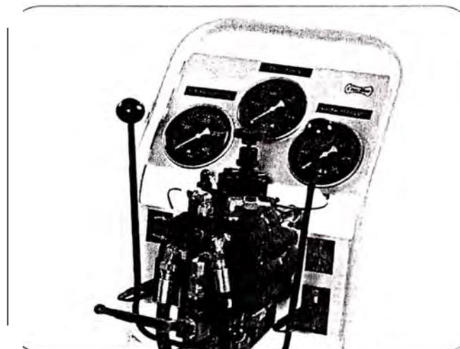
Panel de mando separado con todas las funciones integradas, para permitir una supervisión y control totales durante los ciclos de perforación.
