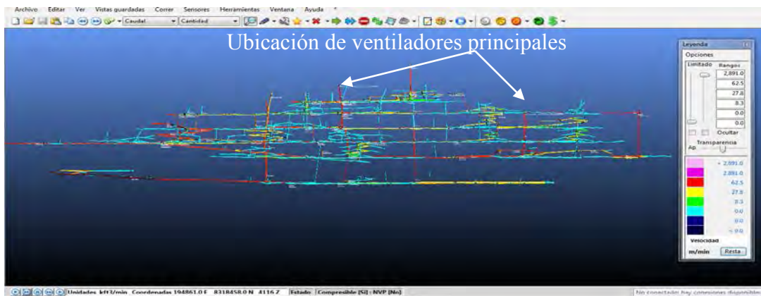
Figura 4.10: Vista Longitudinal del sistema de ventilación de la mina animas (ver anexo 01)
