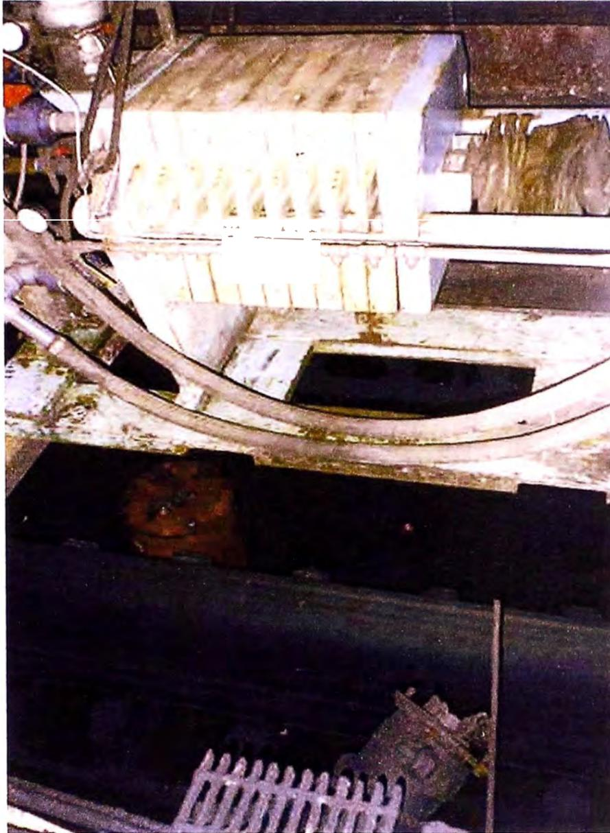
**FIGURA 4 : VISTA DE POSICIÓN DE FILTRO Y FAJA DE DESCARGA DEL KEKE EN PLANTA DE FILTRADO**
