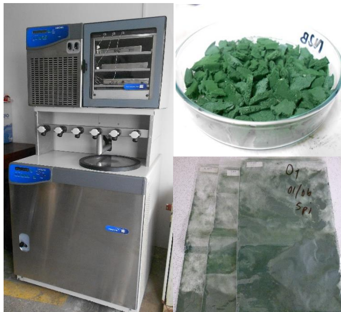
Figura 2.5. Secado de biomasa de la microalga Arthrospira platensis . A la izquierda, se muestra el liofilizador usado (LABCONCO 16L) para liofilizar las muestras de biomasa microalgal. A la derecha, se muestran la biomasa liofilizada y conservado en bolsas ziploc a 4°C.
