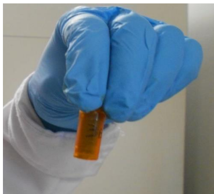
Viales ámbar con filtro PTFE 0,45 \mu m para HPLC
