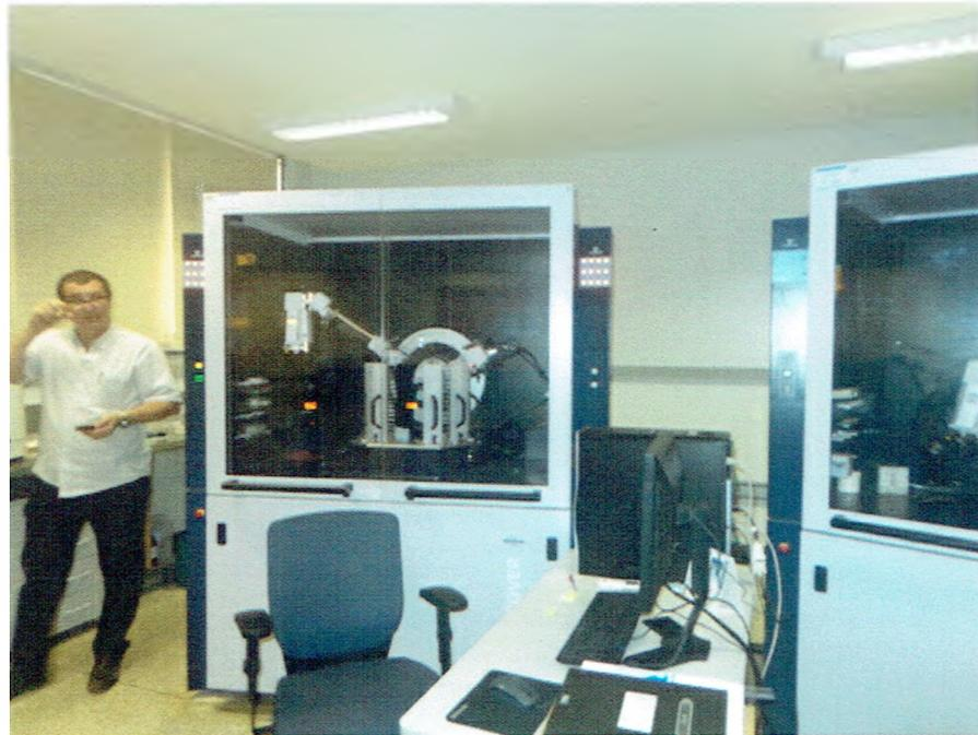
**Figura 2.2.** Difractómetro del “Centro Regional para o Desenvolvimento Tecnológico e Inovação, UFG Goiânia\_Brasil donde se hicieron los análisis de rayos X.
