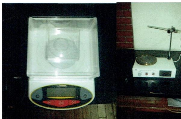
**Figura 3.4.** (a) Balanza digital de 3 decimales. (b) Agitador magnético
