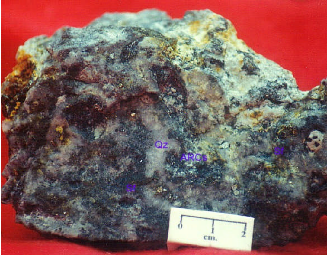
Foto 15: Muestra de Veta, con textura brechoide y drusica con Cuarzo (Qz), Sulfuros (Sf), Arcillas (ARCs) y óxidos de Fe (jarosita-goetita)
