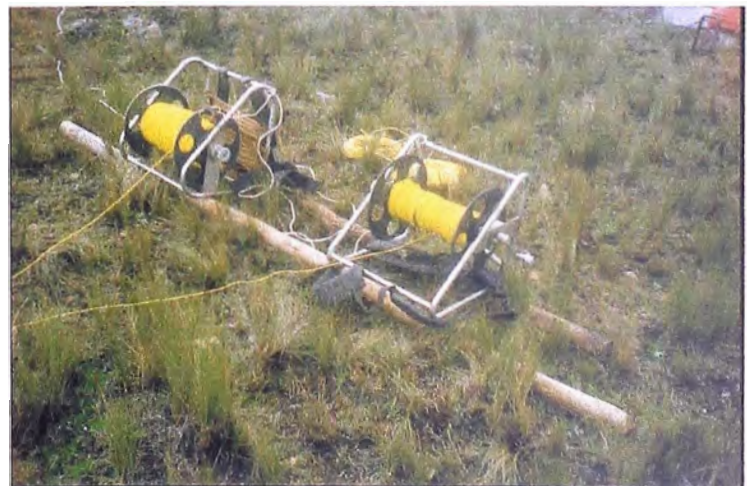
Fotografía N° 12 Carretes de cables conectados a los electrodos utilizados en las líneas geofísicas.
