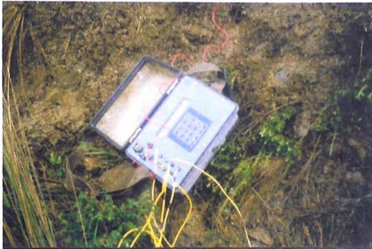
Fotografía N° 13 Voltímetro, mide la diferencia de potencial entre electrodos transmisores y receptores.
