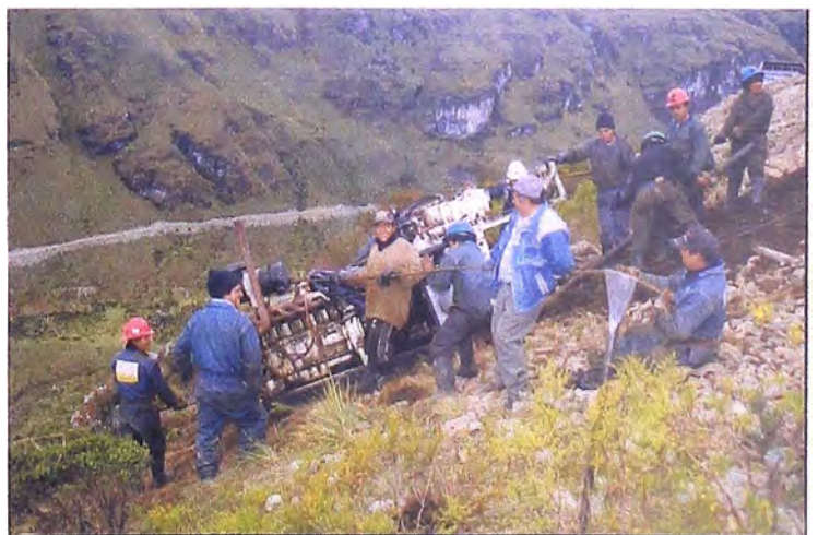
Fotografía N° 19 Traslado de la perforadora LF-70 del taladro SDDH-5 al SDDH-6 a través de una pendiente de 50° aproximadamente.
