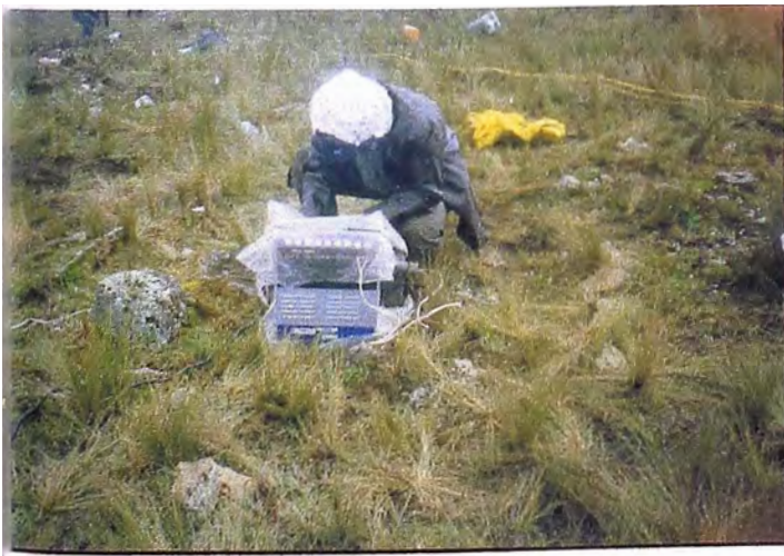
Fotografía N° 11 Fuente de energía generadora de la fuente eléctrica continua durante la prospección geofísica.
