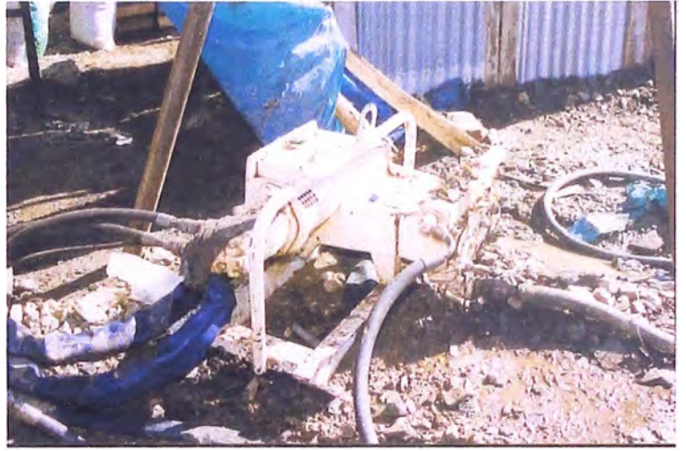
Fotografía N° 17 Bomba succionadora de lodos utilizado en los taladros, forma parte del sistema circulatorio de recuperación de aditivos.
