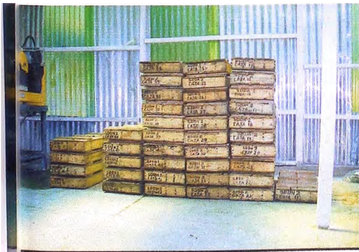
Fotografía N° 18 Cajas para testigos HQ, a la izquierda maquina corta testigos. Casa de logeo.
