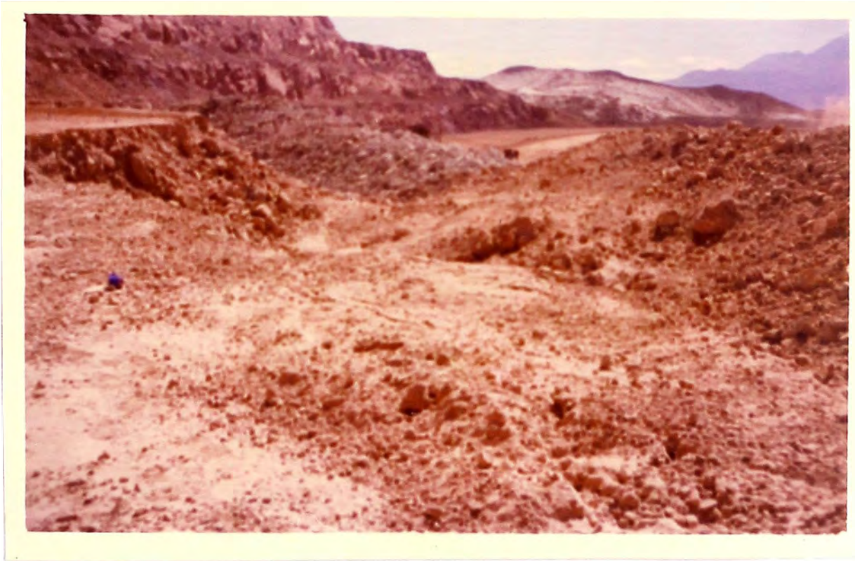
Fig. 14 Fracturamiento hacia atrás (Back – Break) en la zona norte de Cerro Verde Nivel - 2768
