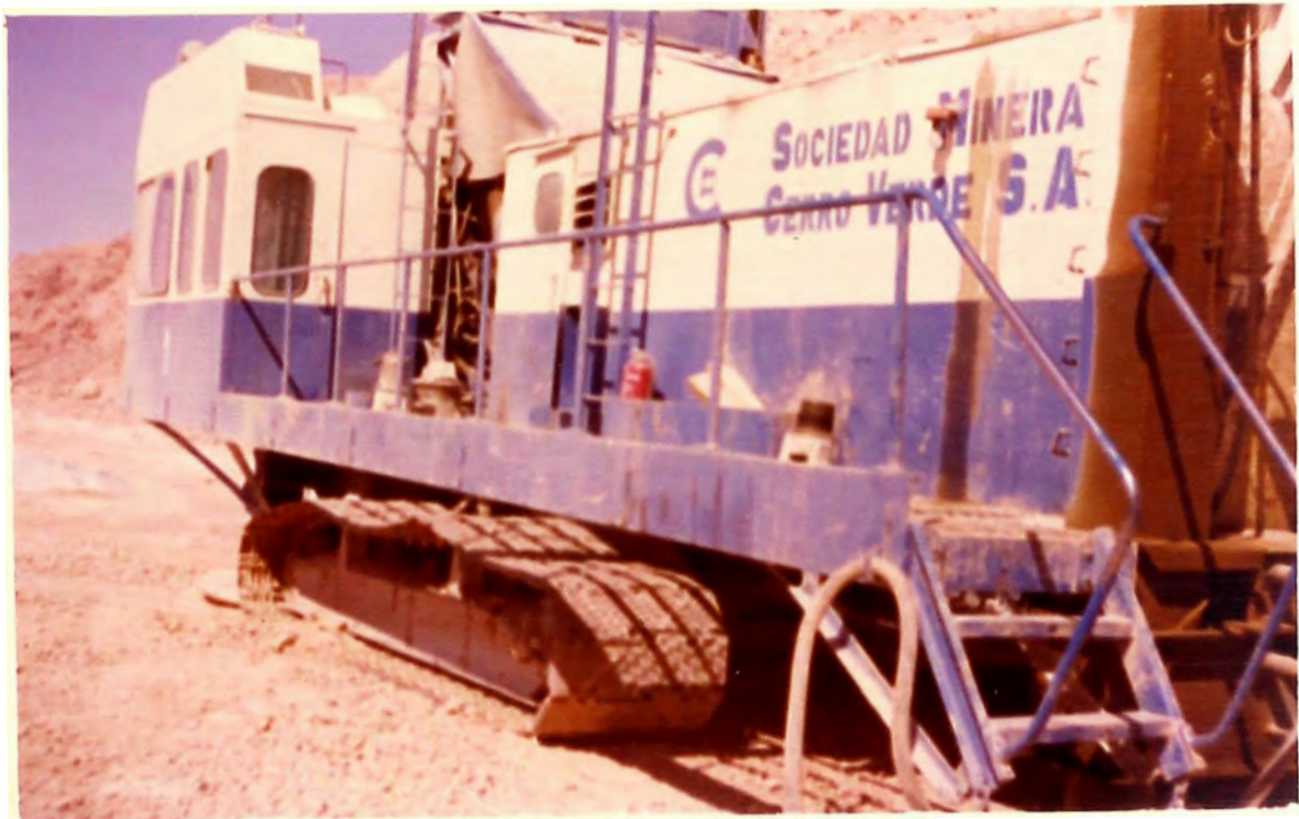
Fig. 12 Perforadora BE-45R en la zona de trabajo, son más antiguas.
