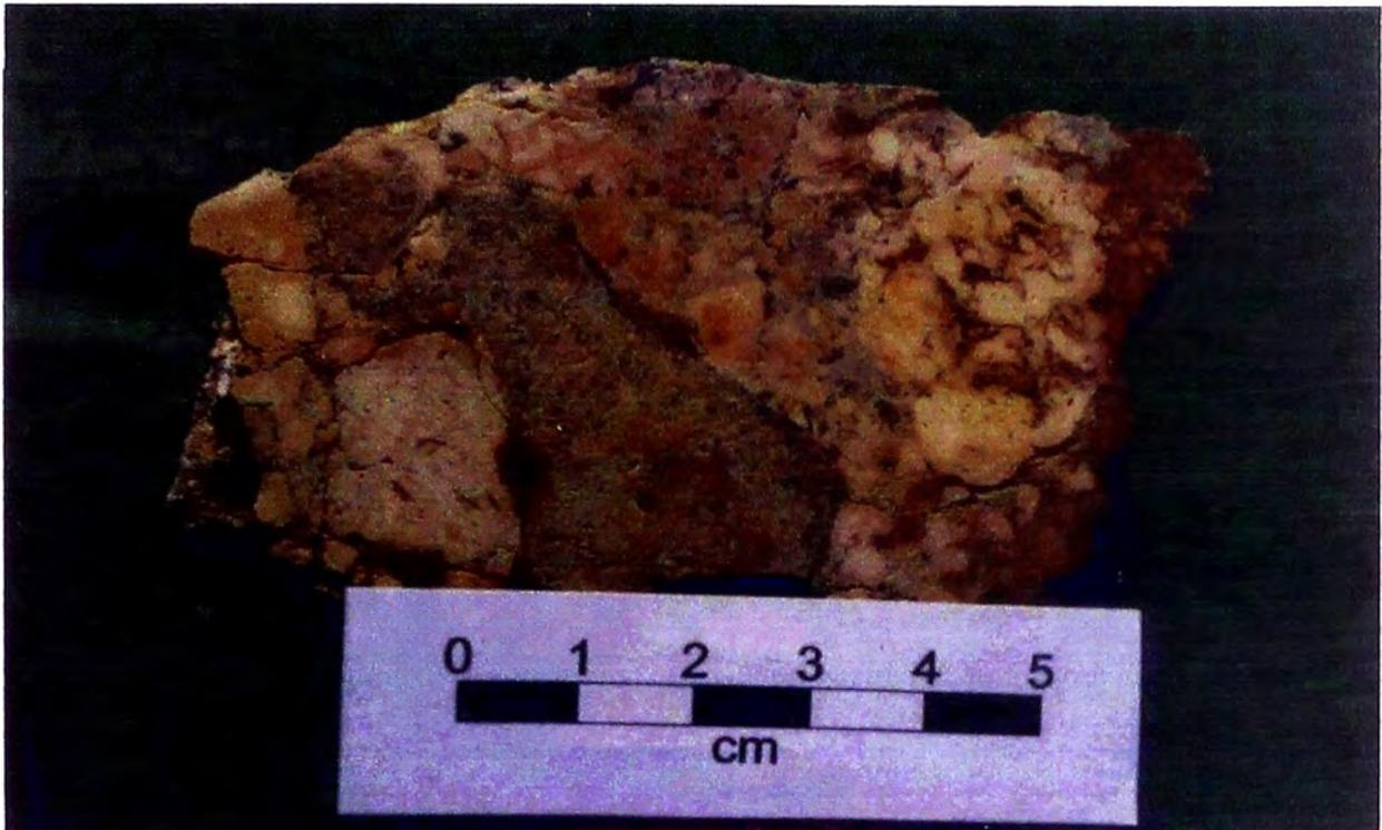
**Figura III.4.2 Alteración Potásica sobre Brecha Hidrotermal**
