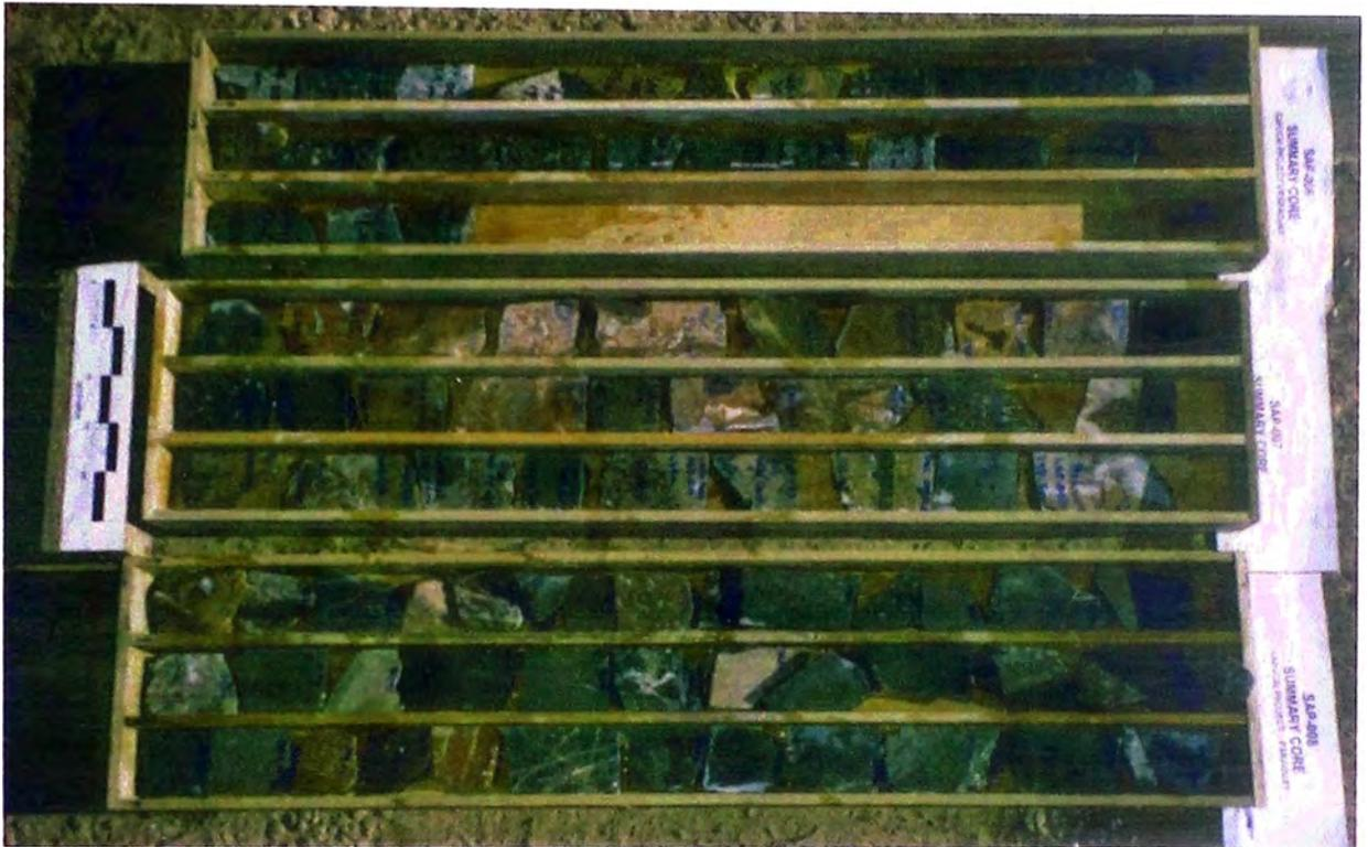
**Figura III.8.7 Cajas Resúmenes de Sondajes SAP-006, 007 y 008**
