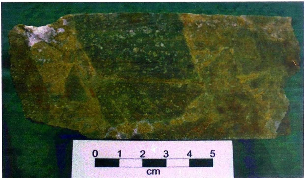
**Figura III.3.3b Brecha de Fracturamiento o Crackle Breccia**
