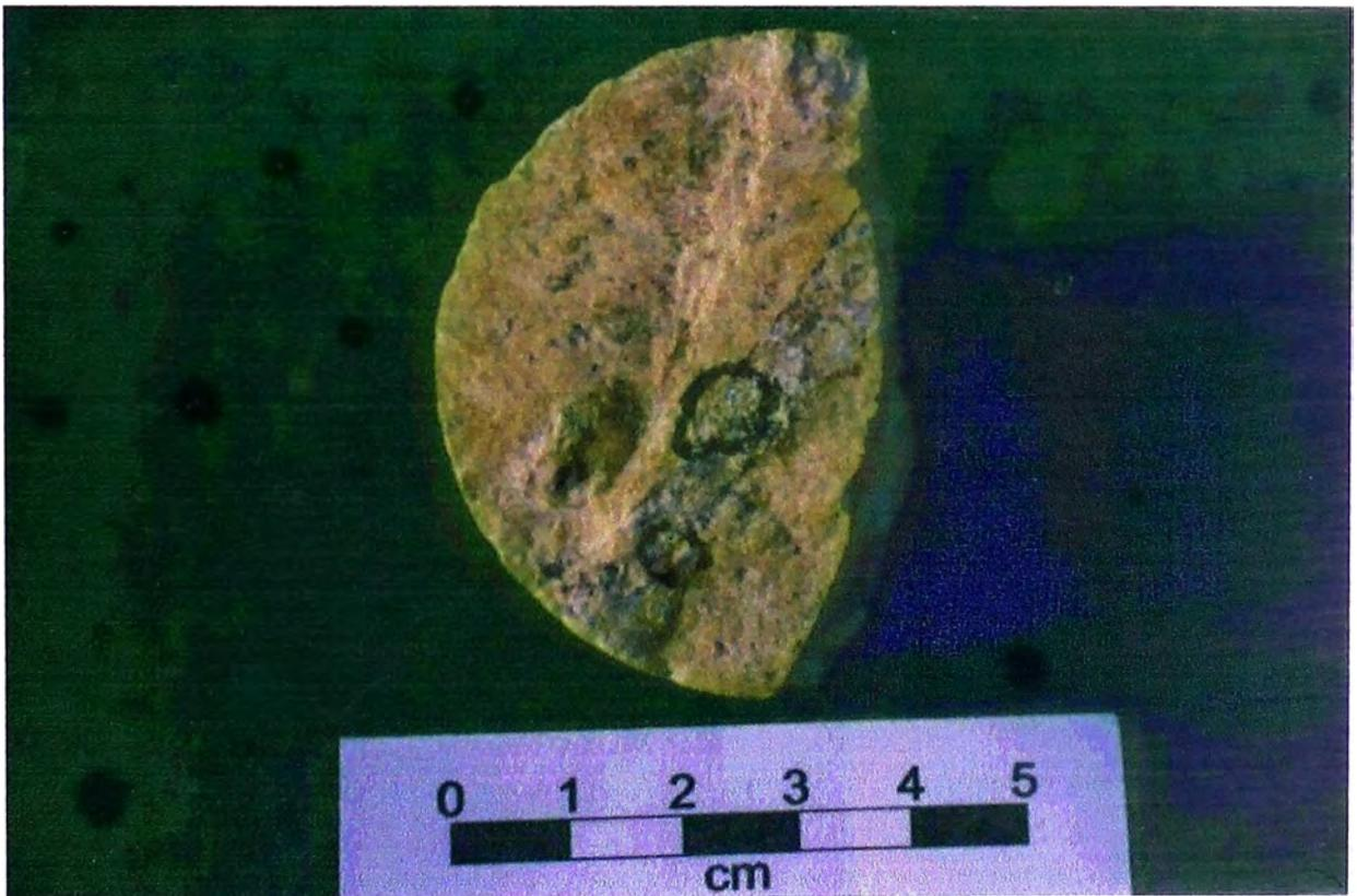
**Figura III.5.4 Testigo de Sondaje DDH-1 sobre Brecha Picuá, vista transversal**
