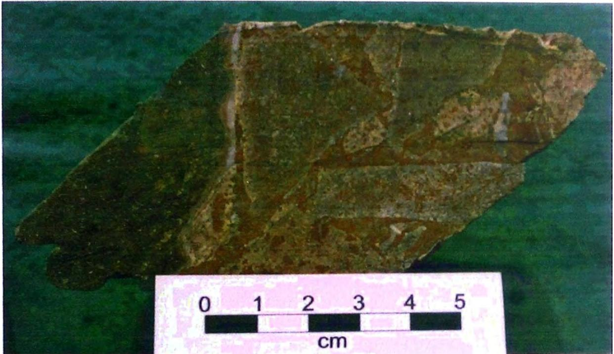
**Figura III.3.3a Brecha de Fracturamiento o Crackle Breccia**
