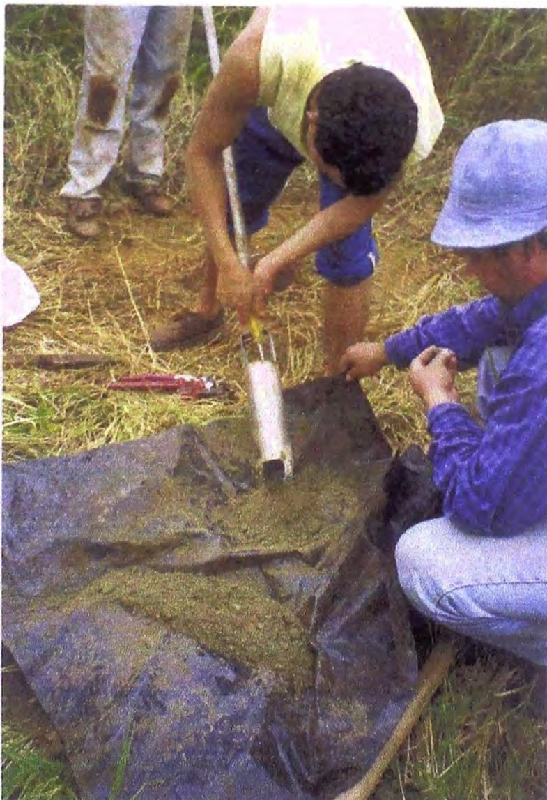
**Figura III.7.3. Muestreo Auger**
