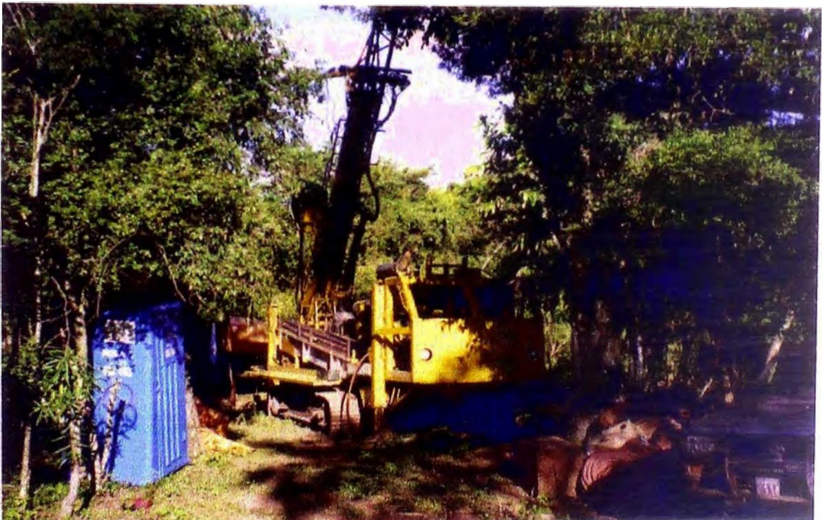
**Figura III.8.4 Perforación en plataforma del sondaje SAP-007 en Sapucaí**
