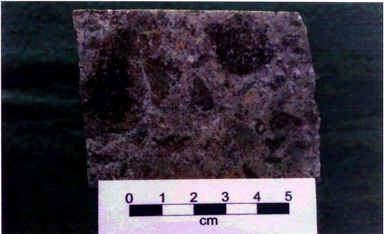
**Figura III.4.6 Alteración Potásica en Brecha Intrusiva**
