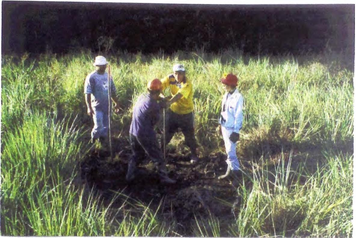
**Figura III.7.2. Toma de Muestras de Suelo por el Método Auger**
