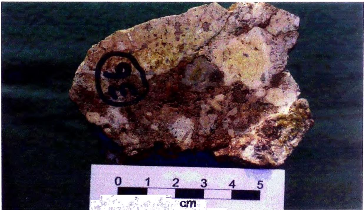
**Figura III.5.2 Muestra de Brecha Hidrotermal con Alteración Potásica**
