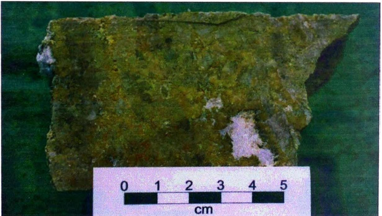
**Figura III.4.9 Carbonatización en Basalto**
