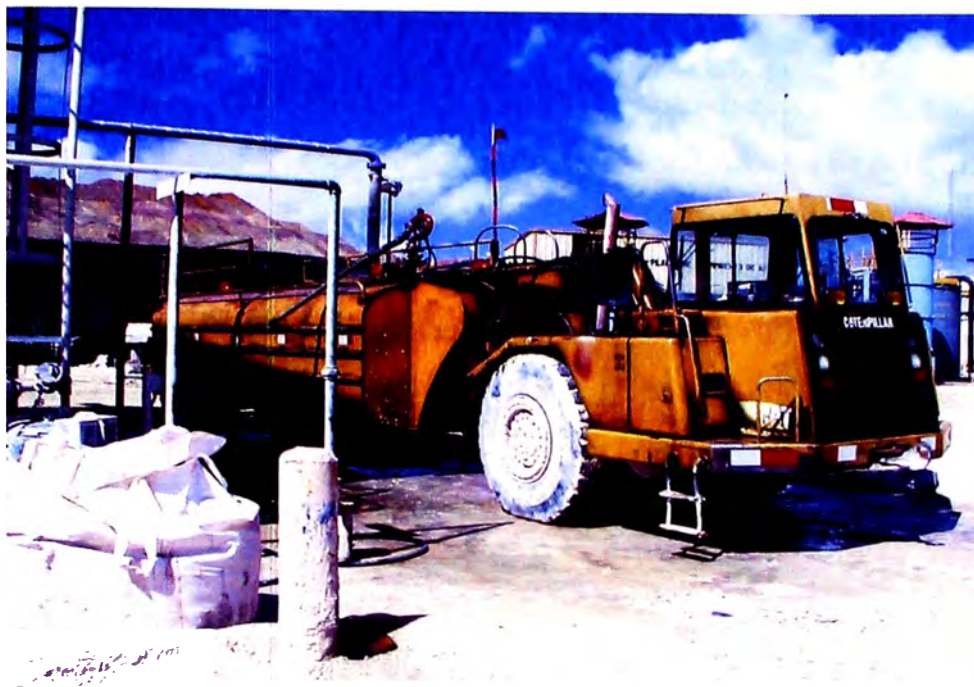
FOTO N° 7: CISTERNA DOSIFICADOR DE CAL.
