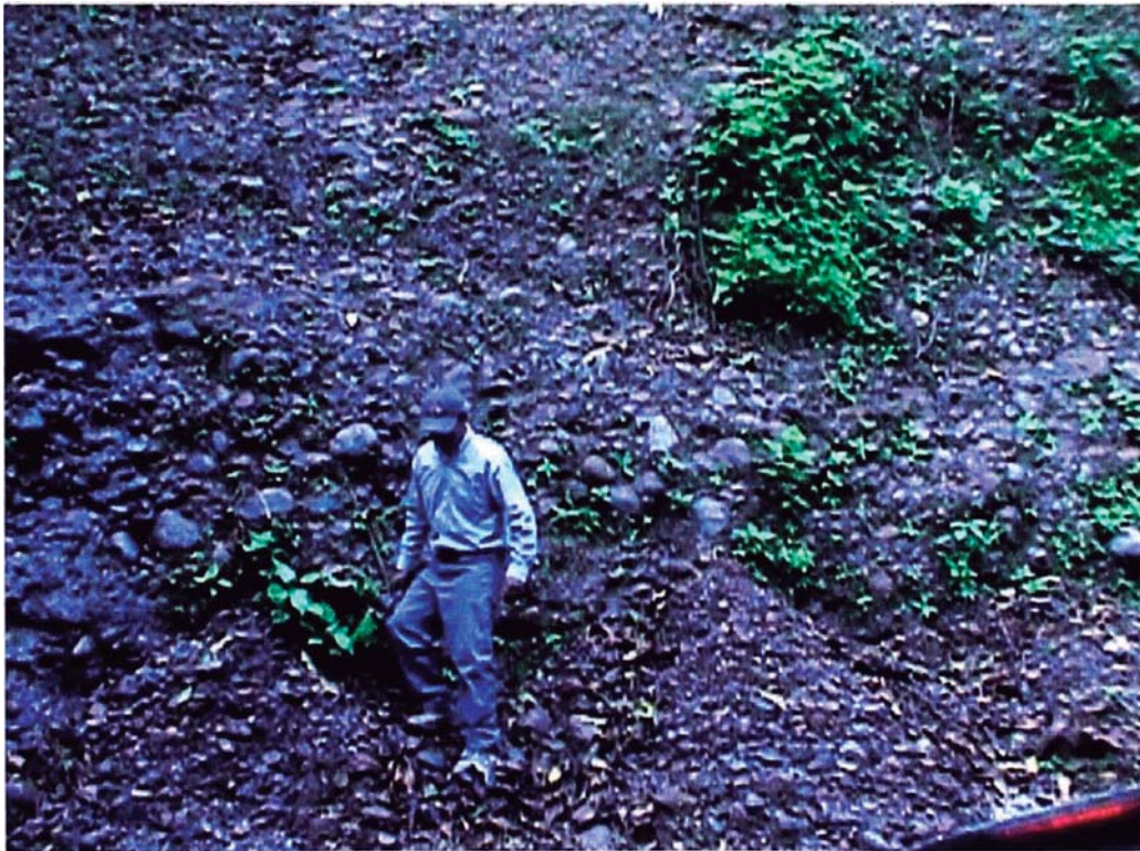
Foto -4: Conglomerado del Grupo Mitú donde se observa los tamaños de los clastos, de guijarros a cantos y la escala de estos, registrado en el tramo de la carretera a San Matías con el punto: PAC042.
