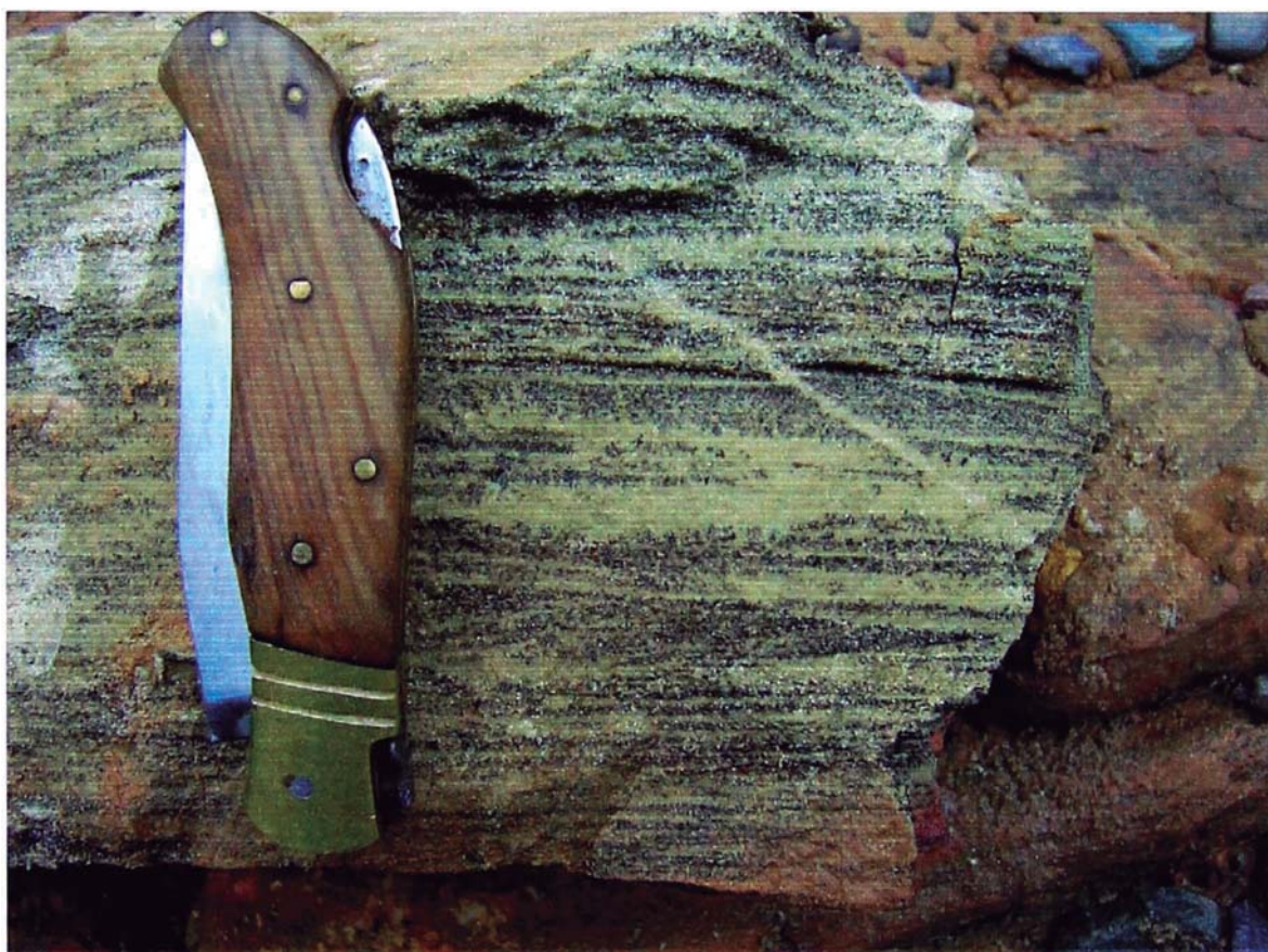
Foto -1: Arenisca eólica cuarzosa de la Formación Ene, de granos finos, redondeados a semi-redondeados con puntos blancos dentro de la matriz intercalados con niveles negros (HC). Registrado en el tramo de la carretera de San Matías con el punto PAC033.
