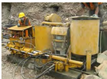
Fig. 2.9. Inyección de anclajes postensados y construcción de los muros estructurales de forma alternada en la obra Javier Prado 200, Magdalena del Mar - Lima. Cortesía Geotécnica S.A.C.
