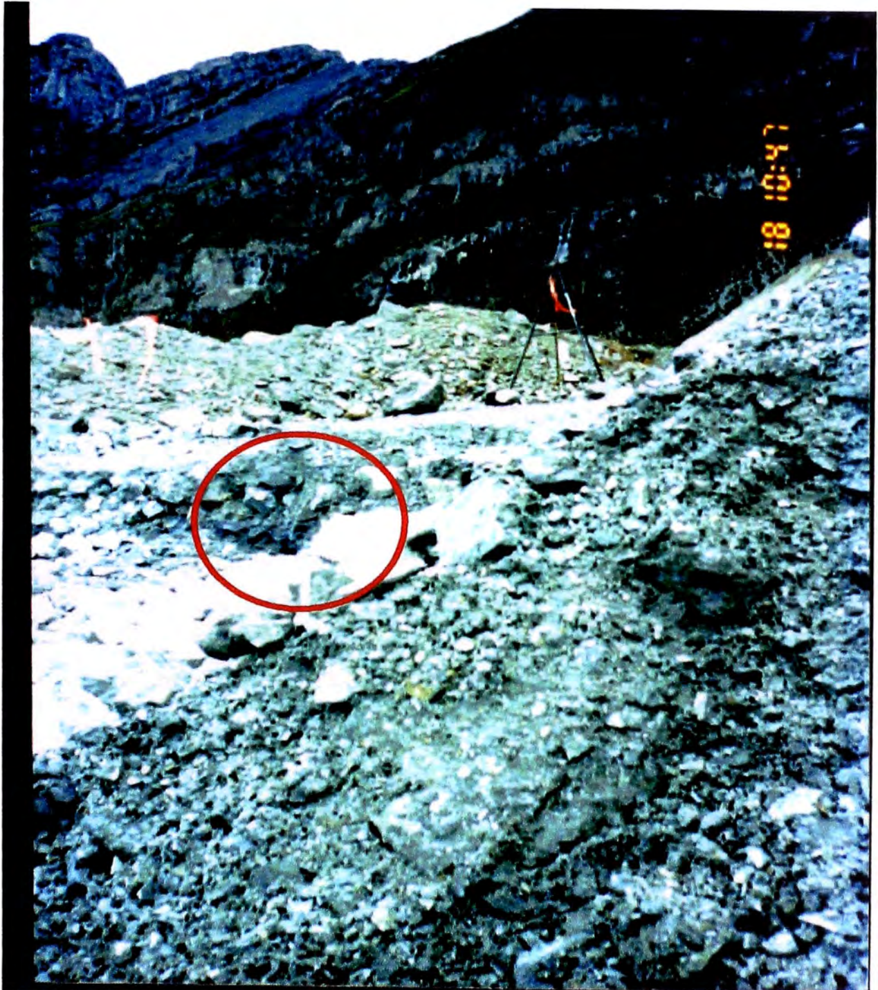
FOTO N °15: EN ESTA VISTA SE PUEDE OBSERVAR QUE EL EXTENSÓMETRO ESTA REGISTRANDO UN HUNDIMIENTO, OCACIONANDO QUE LAS LECTURAS SEAN MÁS CONTINUAS.
