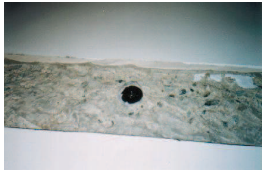
Foto 1.4 Testigo adherido al concreto mediante adhesivo para el test de adherencia.
