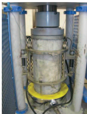
Foto 4.4. Ensayo de compresión de concreto de viga 1A
