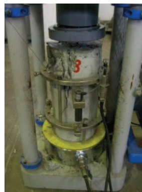
Foto 4.5. Ensayo de compresión de concreto de viga 2B
