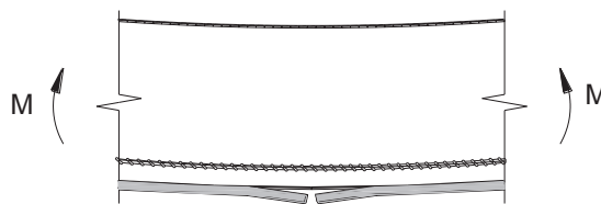
Figura 1.3 Ruptura de la platina FRP
