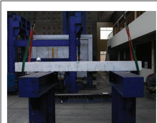
Foto 4.43 Vista frontal de pre-agrietamiento de la viga 3C
