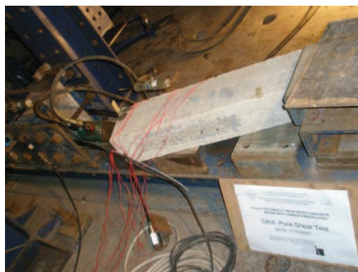
Foto 4.10 Falla prematura del sistema SIKA Carbodur en uno de los lado del espécimen de concreto
