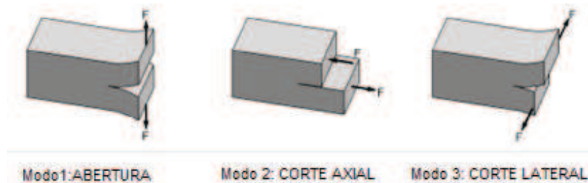
Figura 2.1 Movimientos de propagación de grietas
