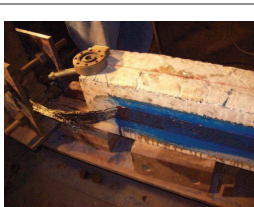
Foto 4.11 Lámina de fibra de carbono con adhesivo en la longitud libre endurecida (por una mala colocación) que genero un desbalance en la fuerza durante el ensayo.
