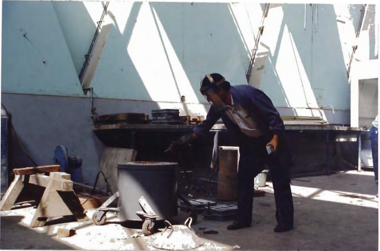
Foto N° 4.05 CARGADO DEL HORNO
