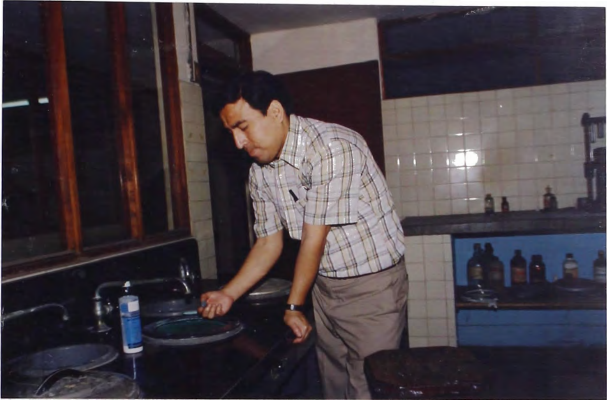
Foto N° 5.07 ETAPA FINAL DEL PULIDO EMPLEANDO ALUMINA
