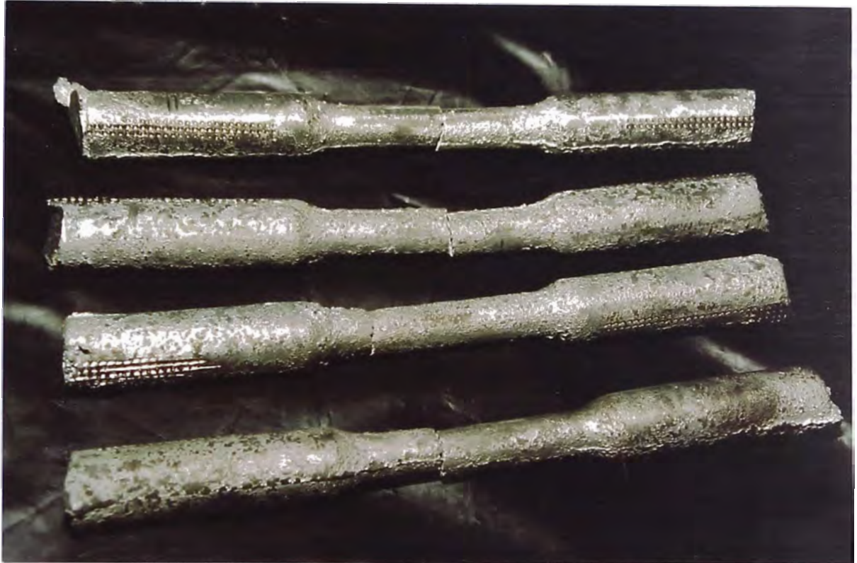
Foto N o 5.01 PROBETAS TRACCIONADAS EN EL LAB. N o 9 - FIGMM-UNI
