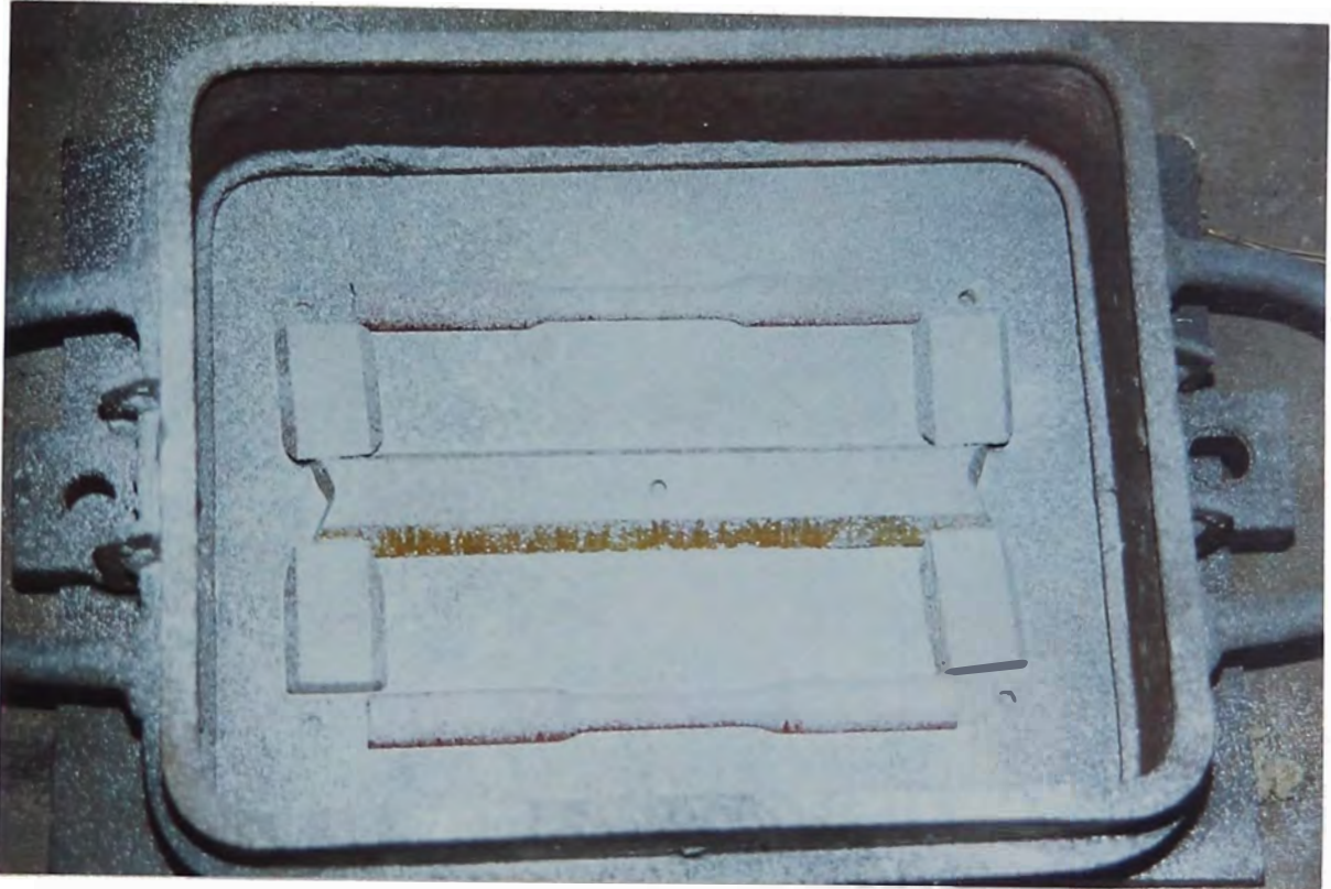
Foto Nº 4.01 INICIANDO EL MOLDEO DE LAS PROBETAS
