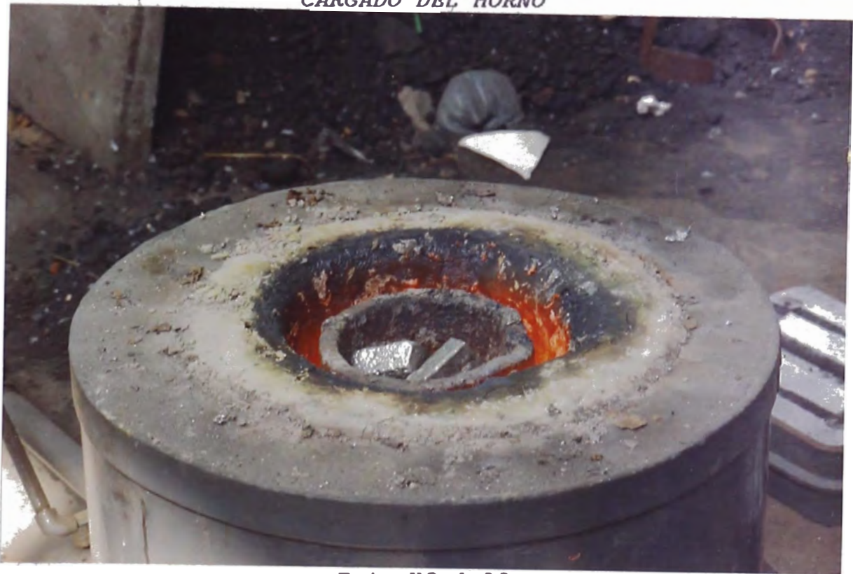
Foto N° 4.06 CRISOL CON SU CARGA LISTO PARA FUNDIRSE
