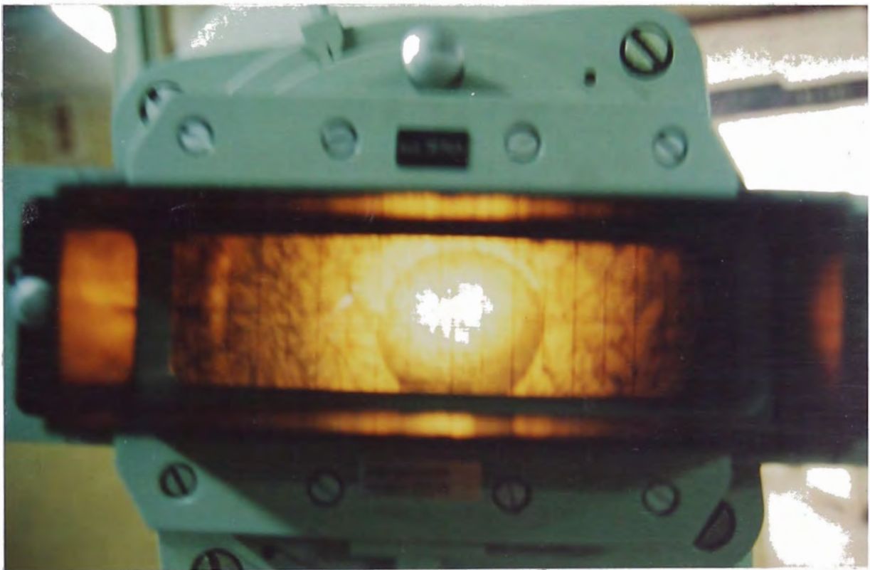
Foto Nº 5.04 LECTURA DEL DIAMETRO DE HUELLA Y CALCULO DE DUREZA BRINELL
