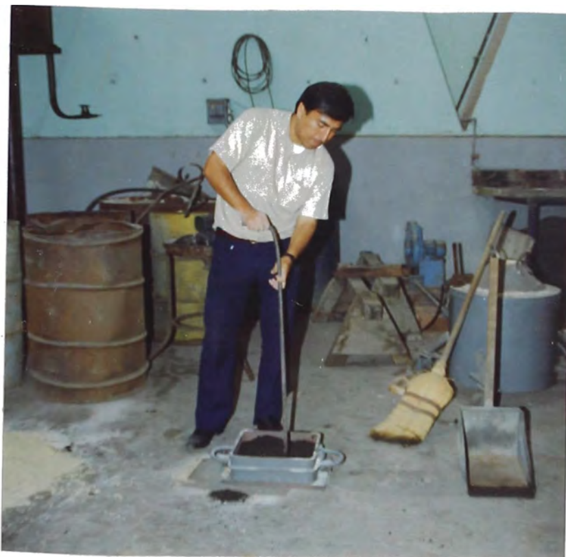
Foto N° 4.03 AGREGAR EL MATERIAL DE RELLENO Y TACONEAR
