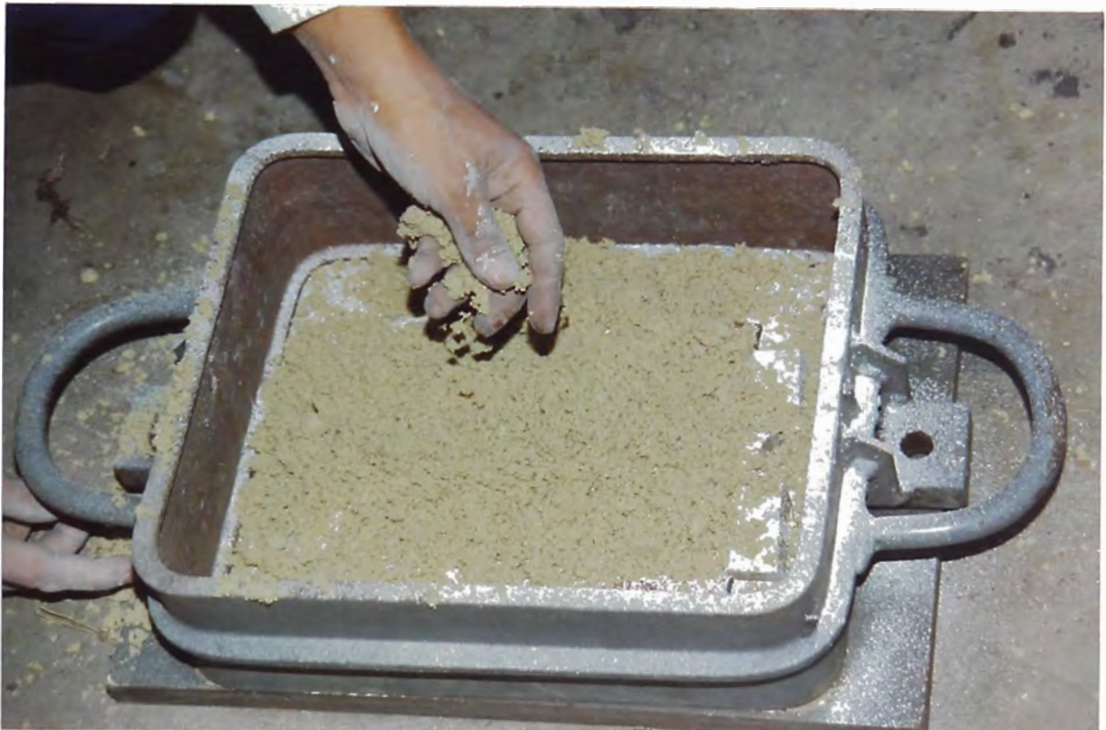
Foto Nº 4.02 HECHAR LA ARENA SILICE Y PRESIONAR MANUALMENTE
