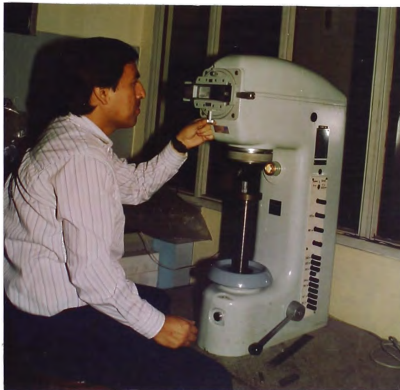
Foto N o 5.02 REGULANDO PARA TOMAR DUREZA
