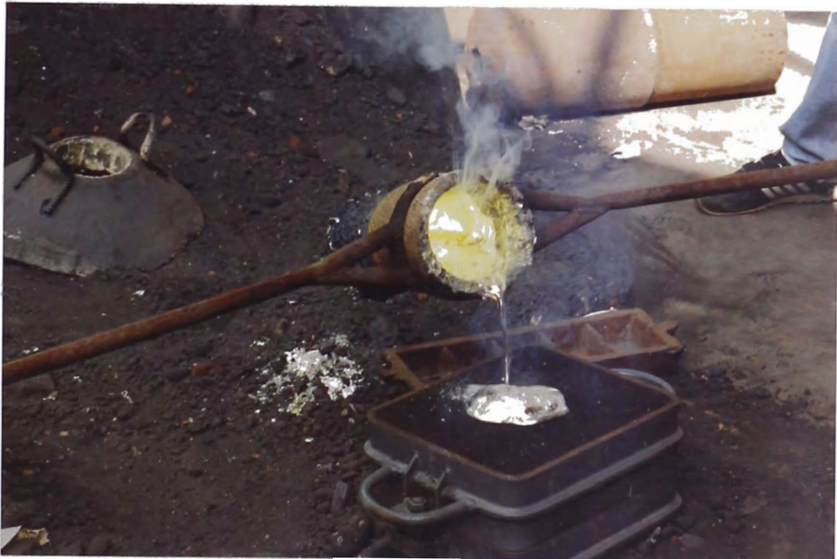
Foto Nº 4.08 A) PROCESO DE COLADA DEL Zn-27Al
