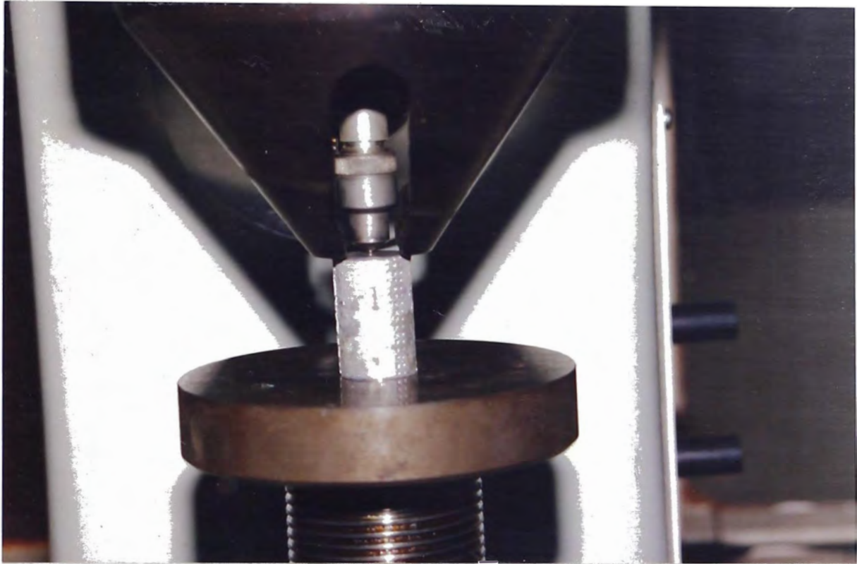
Foto Nº 5.03 APLICANDO LA CARGA A LA PROBETA
