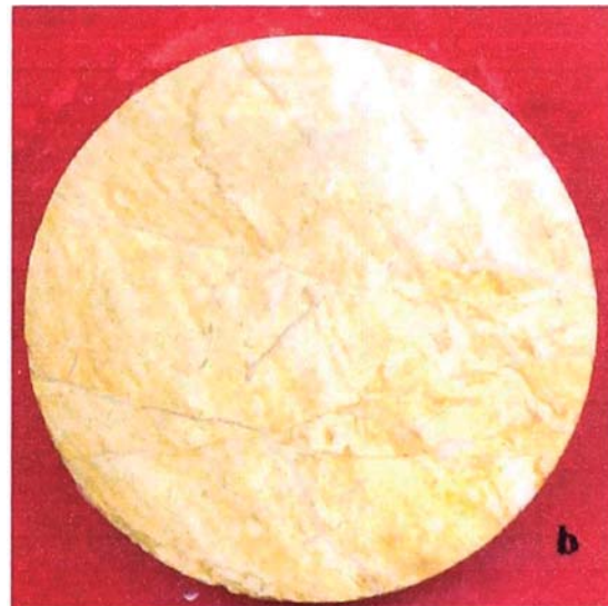
Figura 11a: DDH AH 03, línea HQ (diámetro 6.35 cms) a la profundidad de 122.50 mts caliza gris con estructura laminada y playas de chert gris oscuro craquelada.
