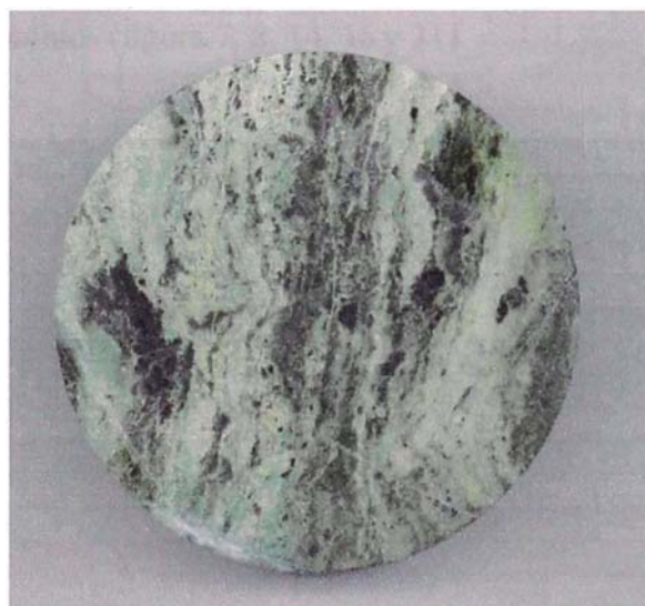
Figura 13: DDH AH 03, línea HQ (diámetro 6.35 cms) a la profundidad de 327.85 mts hornfels de piroxeno (playa verde) y biotita (playa marrón) en bandas coloformes, y calcita rellenando fracturas.
