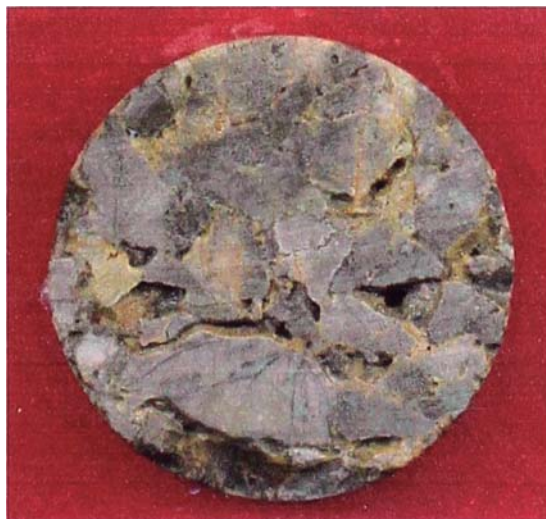
Figura 36: DDH AH 07, línea HQ (diámetro 6.35 cms) a la profundidad de 135.60 mts caliza gris claro con oquedades producto del proceso cárstico.
