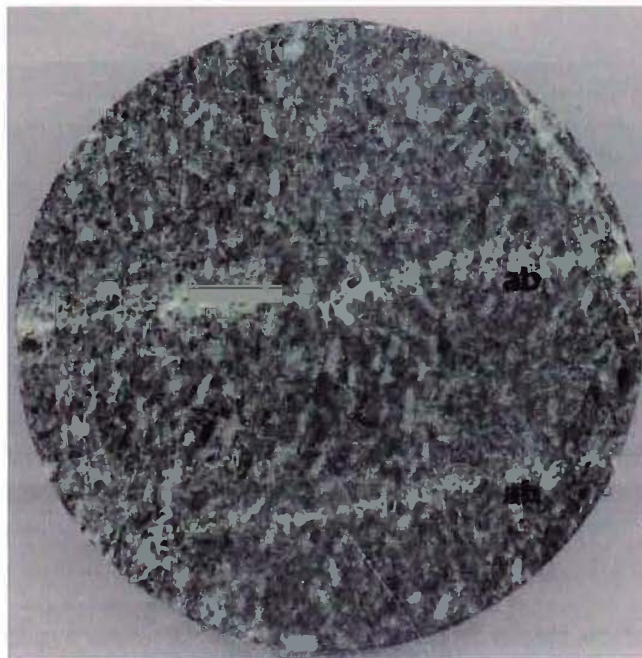
Figura 14: DDH AH 01, línea HQ (diámetro 6.35 cms) a la profundidad de 49.20 mts es la “roca fluidal” de composición diorítica, con alteración de los minerales máficos a clorita y albitización (ab) de las plagioclasas en el borde de las fracturas finas rellenas de calcita.
