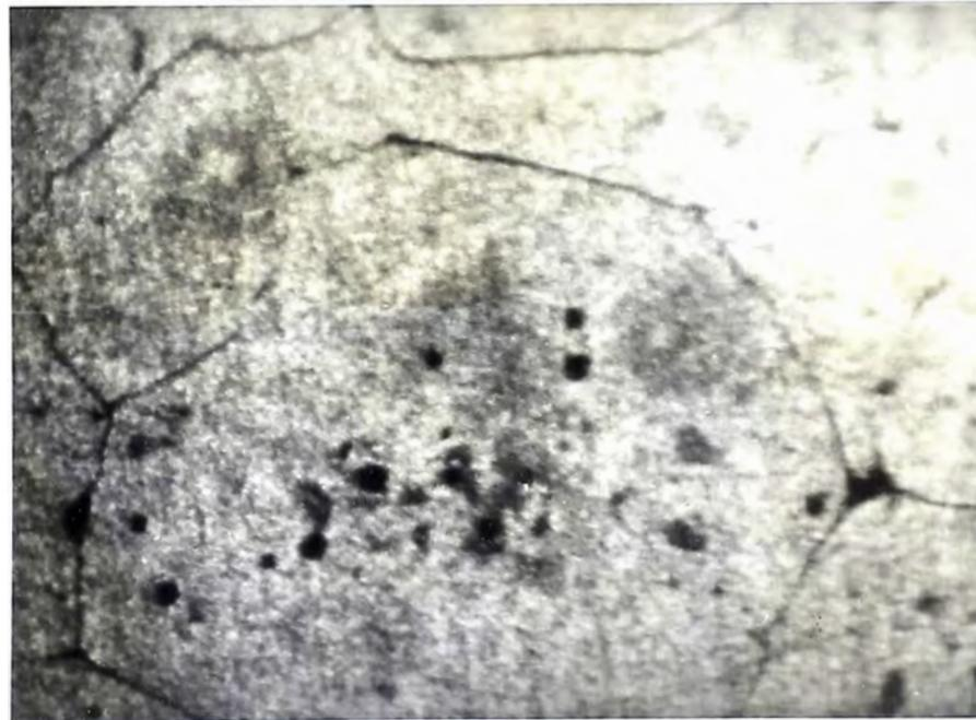
MICROESTRUCTURA DE PRECIPITACION A 500°C
