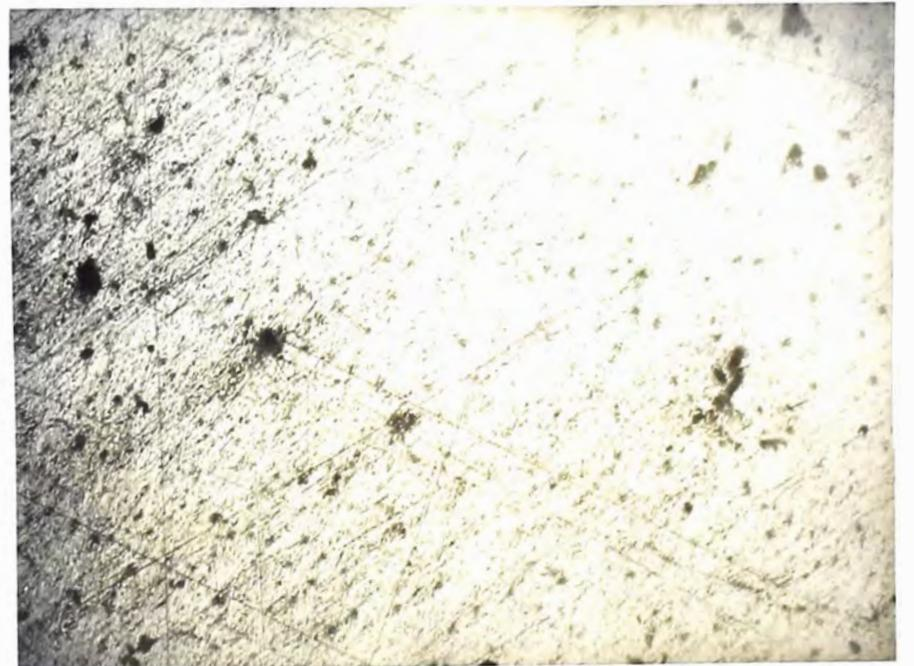
MICROESTRUCTURA DE PRECIPITACION A 200°c
