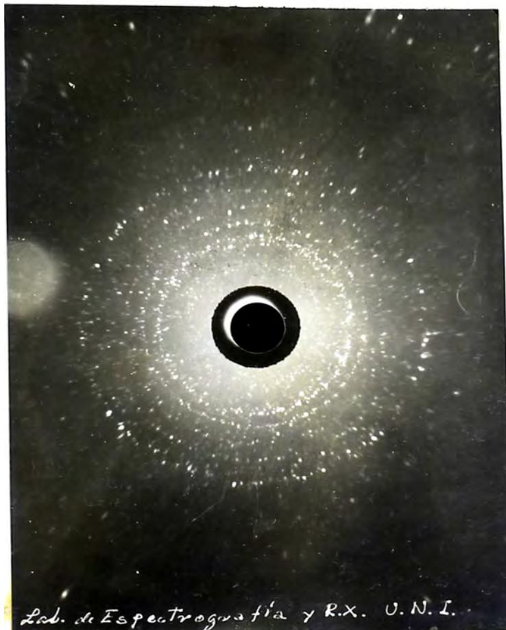
Probeta laminada y recocida durante 4h a 700°C
