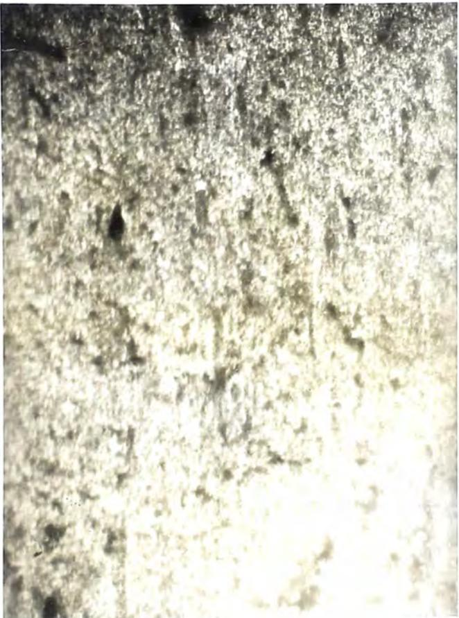
MICROESTRUCTURA DE PRECIPITACION A -77°C
