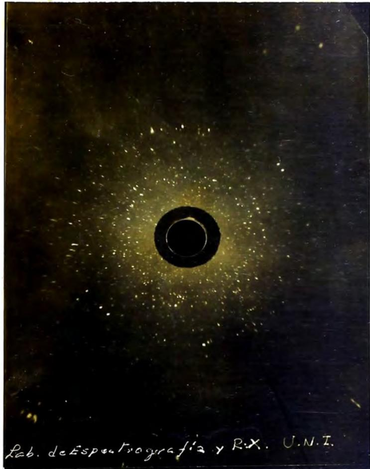
Probeta laminada y recocida durante 4h a 600°C
