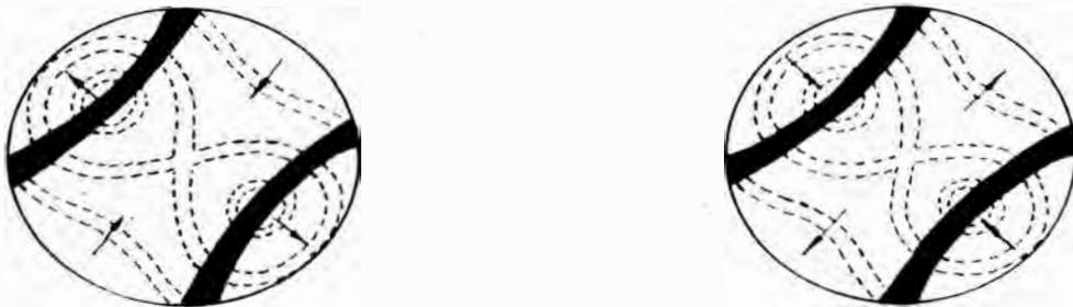
Fig # 18.- Sentido de movimiento de los colores de interferencia debido al efecto que produce el uso de una placa de mica o de cuarzo.- En el primer caso la figura es Biaxial positivo, en el segundo Biaxial negativo.
