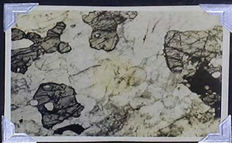
**Fot.# 36.-** Cristales de Epidota en agregados granulares. Relieve alto.
