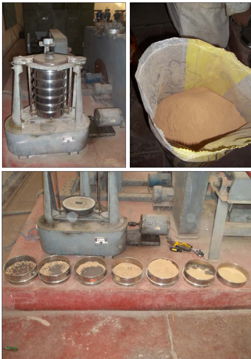
Figura 14. Acondicionamiento del aserrín de capirona. Se usó una tamizadora Ro-Tap con 6 mallas Tyler (Nº 8, 10, 16, 30, 50 y 100) y plato ciego.
