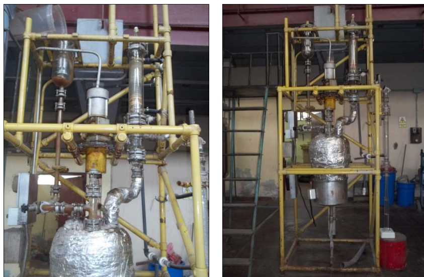
Figura 17. Destilador por lote a nivel banco. En este equipo destilador de una sola etapa se realizaron diversas pruebas de destilación de los mostos fermentados, tomando datos (densidad, grado alcohólico y temperatura) de los cortes volumétricos de muestra del etanol destilado puntual y acumulado durante cada una de las experiencias.
