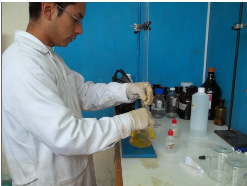
Figura 8. Determinación de la concentración inicial de NaOCl (Crp i ). Para cada galonera utilizada se determinó la concentración inicial de cloro libre de la siguiente manera: se tomaron 20 mL de solución y se diluyeron con agua destilada a 1 L; después se tomaron 25 mL de la mezcla y se le adicionó 1 g de cristales de yoduro de potasio, acidificando luego con 4 mL de ácido acético glacial; finalmente, la mezcla resultante se tituló con una solución titulante patrón de Na 2 S 2 O 3 0,1 N hasta que el color amarillo desapareciera (para afinar el "punto de viraje" se agregó 1 mL de solución de almidón soluble y se continuó la titulación hasta que el color azul oscuro desapareciera completamente).
