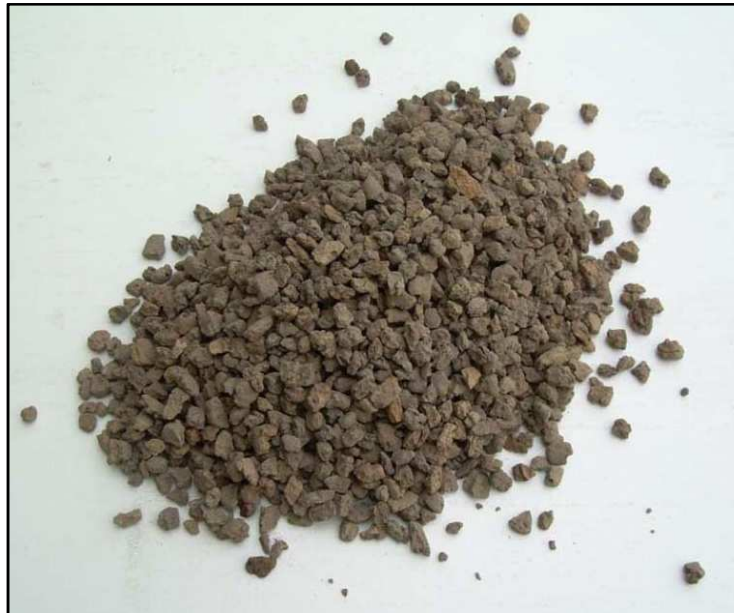
Figura 4.10: Arcilla expandida utilizada como media de filtración
