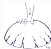
Fig. 6.3 Rotura por alargamiento de un lámina de doble curvatura.
