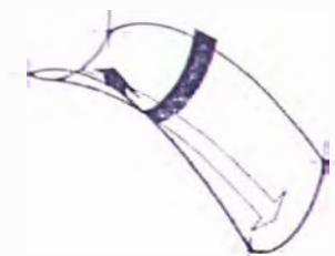
Fig. 6.5 Superficie anticlastica o hiperbólica.
