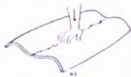
Fig. 6.2 Rotura por flexión de una lámina de curvatura simple
