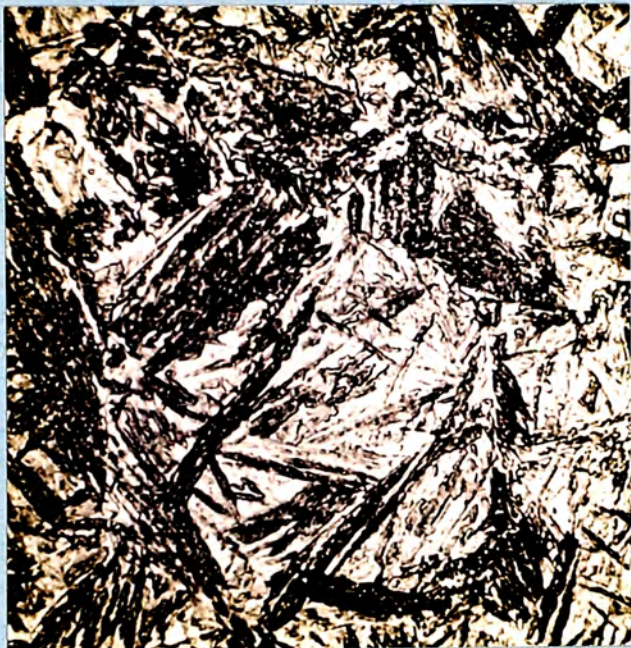
FIG. 50: Micrografía V (1600X). Matriz martensítica (60%) con bainita acicular notoria (40%).
