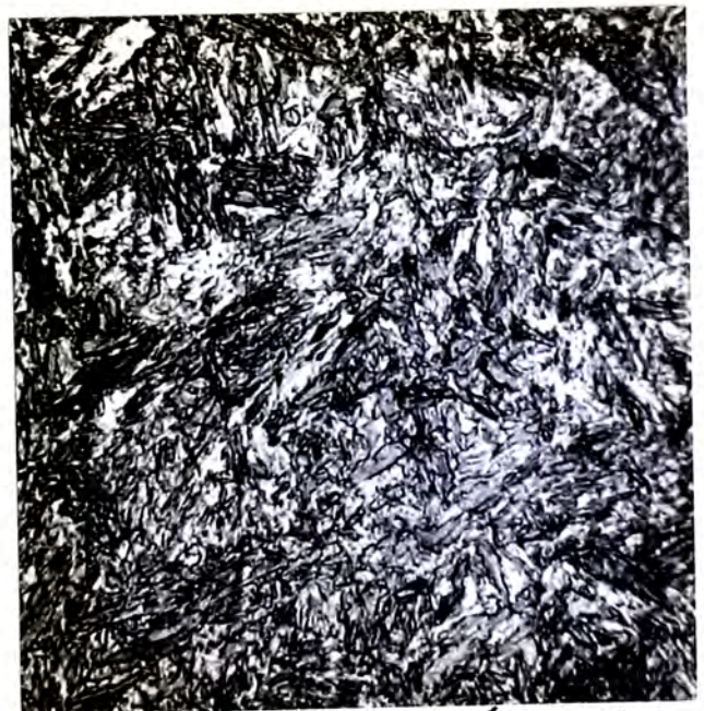
FIG. 60: Matriz martensítica fina ya definida, con probable austenita retenida. Temple a 850°C, 56 HRC. 1600X.
