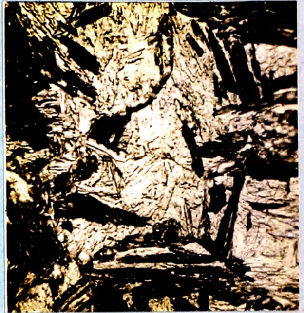
FIG. 47: Micrografía O (1600X). Matriz martensítica (60%) con bainita (40%).
