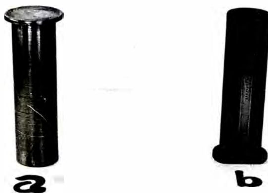
Fig. 33 : Probetas Jominy. Antes del Ensayo (a) y luego del mismo (b).
