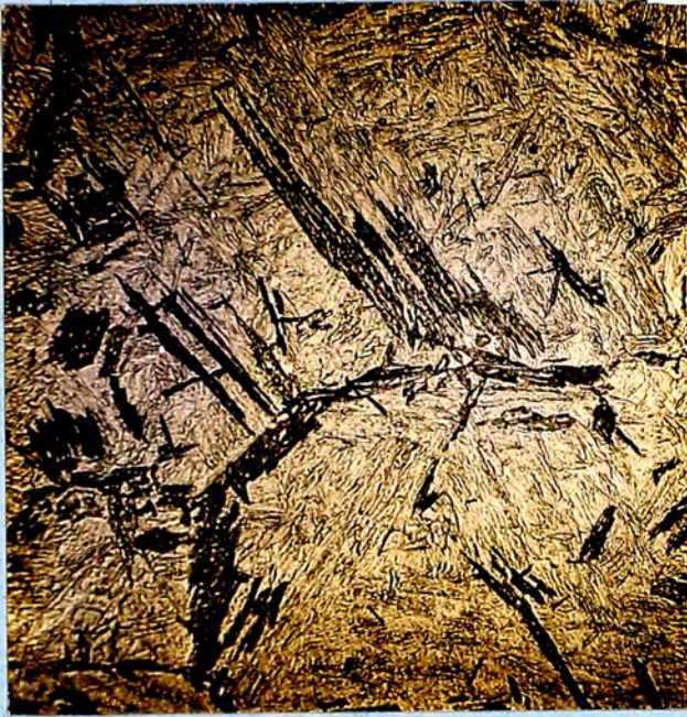
FIG. 46: Micrografía M (1600X). Agujas finas de martensita, y bainita inter é intragranular (15%).
