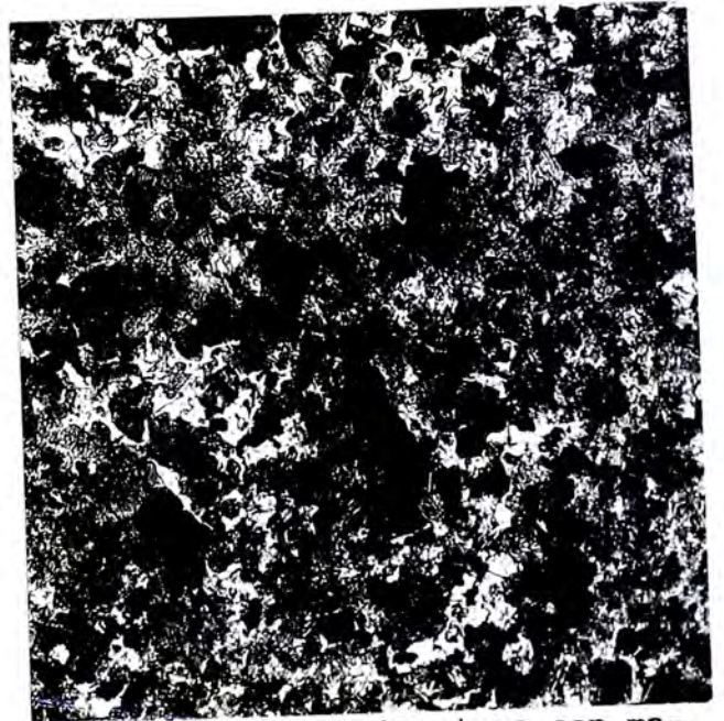
FIG. 72: Microestructura con matriz perlítica lamelar gruesa y ferrita. Acero SAE 6140 recocido a 850°C; 90 HRB. 400X.
