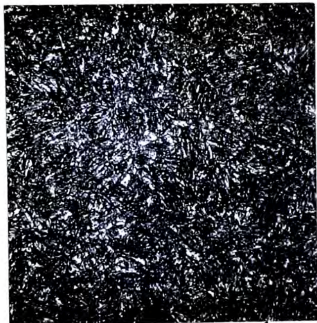
FIG. 65: Microestructura finísima, con desaparición de la martensita y supuesta precipitación del Fe_3C . Revenido a 350°C, 41 HRC. 1600X.
