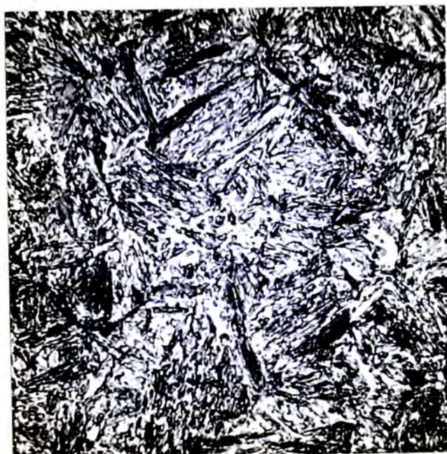
FIG. 63: Martensita no uniforme é irregular. Temple a 940^{\circ}\text{C} , 55 HRC. 1600X.
