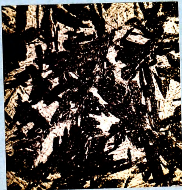
FIG. 52: Micrografía E (1600X). Matriz bainítica (70%) con áreas martensíticas (30%).
