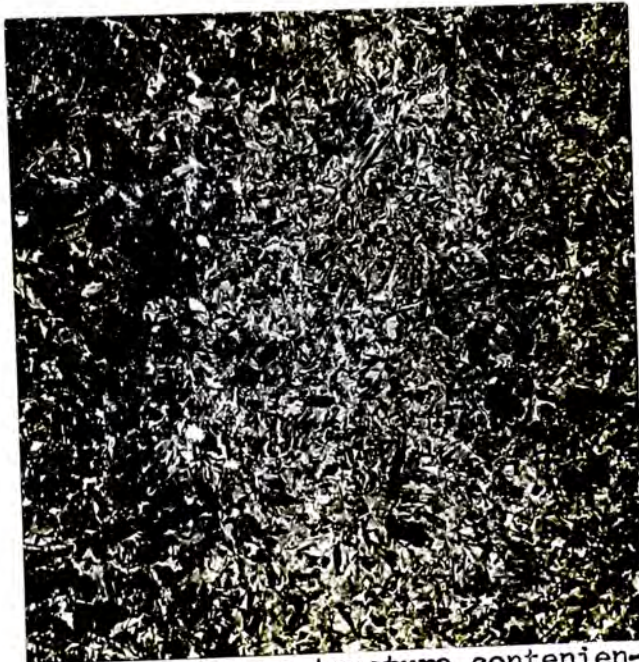
FIG. 71: Microestructura conteniendo ferrita (20%), perlita (65%), sorbita (5%) y martensita (10%). Normalizado a 850°C; 29 HRC. 500X.
