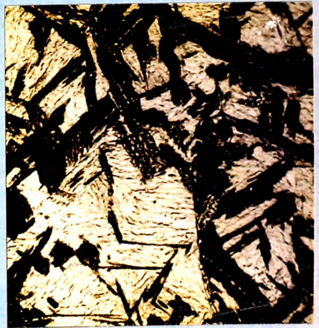
FIG. 49: Micrografía G (1600X). Matriz martensítica (60%) con bainita (40%).
