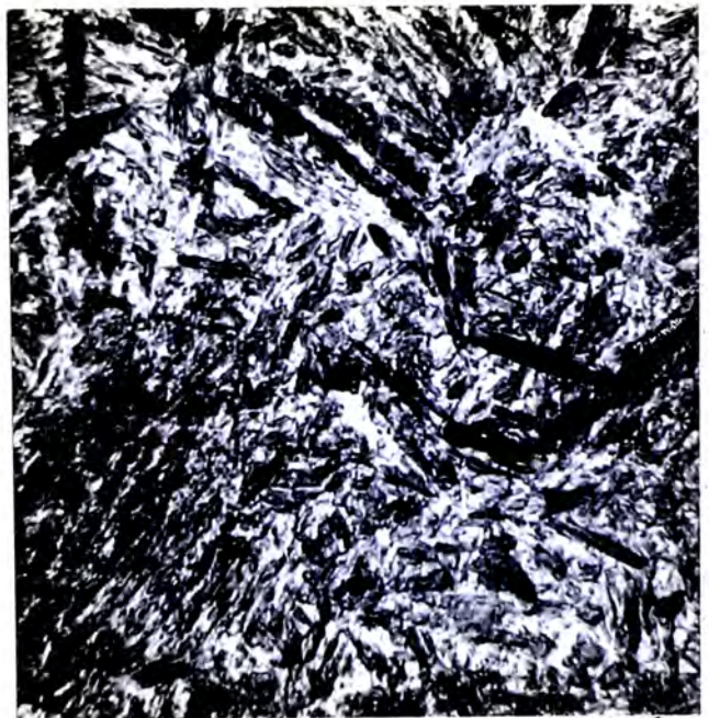
FIG. 58: Microestructura martensítica no uniforme (agujas irregulares groseras y finas) con probable austenita retenida. Temple a 790°C, 54 HRC. 1600 X.
