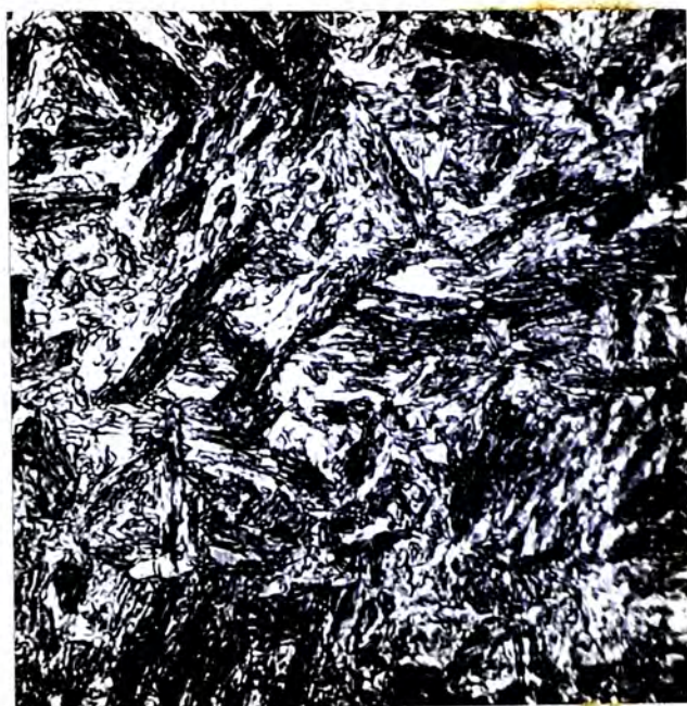
FIG. 62: Microestructura martensítica con agujas gruesas irregulares. Temple a 910^{\circ}\text{C} , 56 HRC. 1600X.
