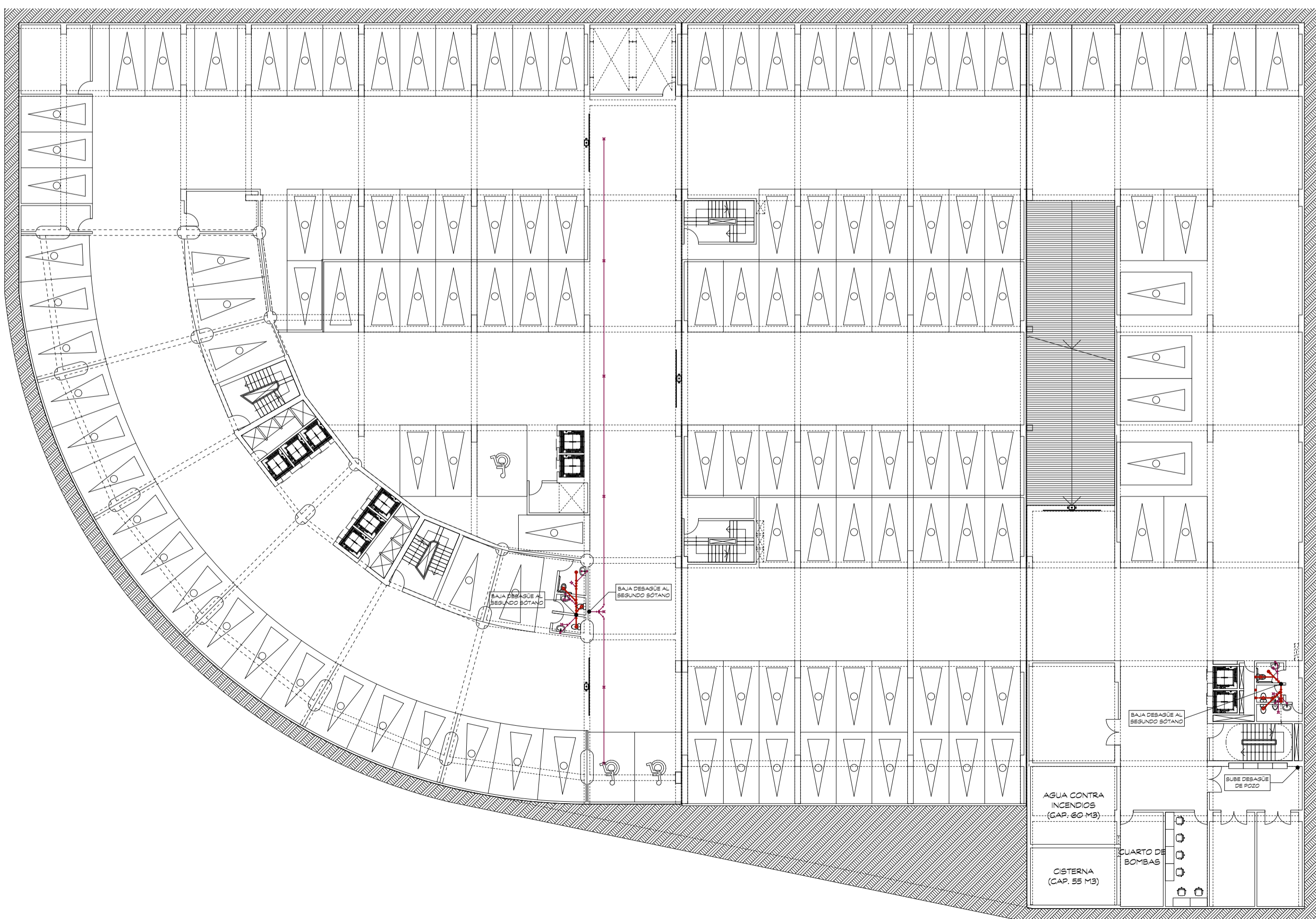
DESAGÜE - PRIMER SÓTANO
