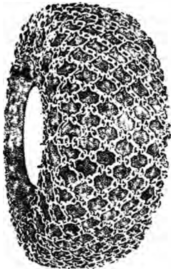
En las cadenas Erlau las mallas de cadenas forman conjuntos de cuatro puntos.
