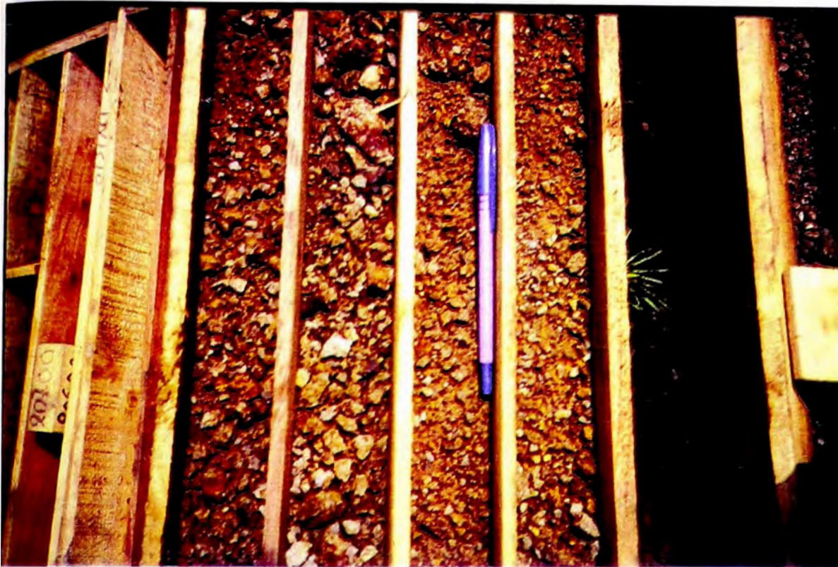
CAJA DE PERFORACION DIAMANTINA CON ROCA TIPO 2
