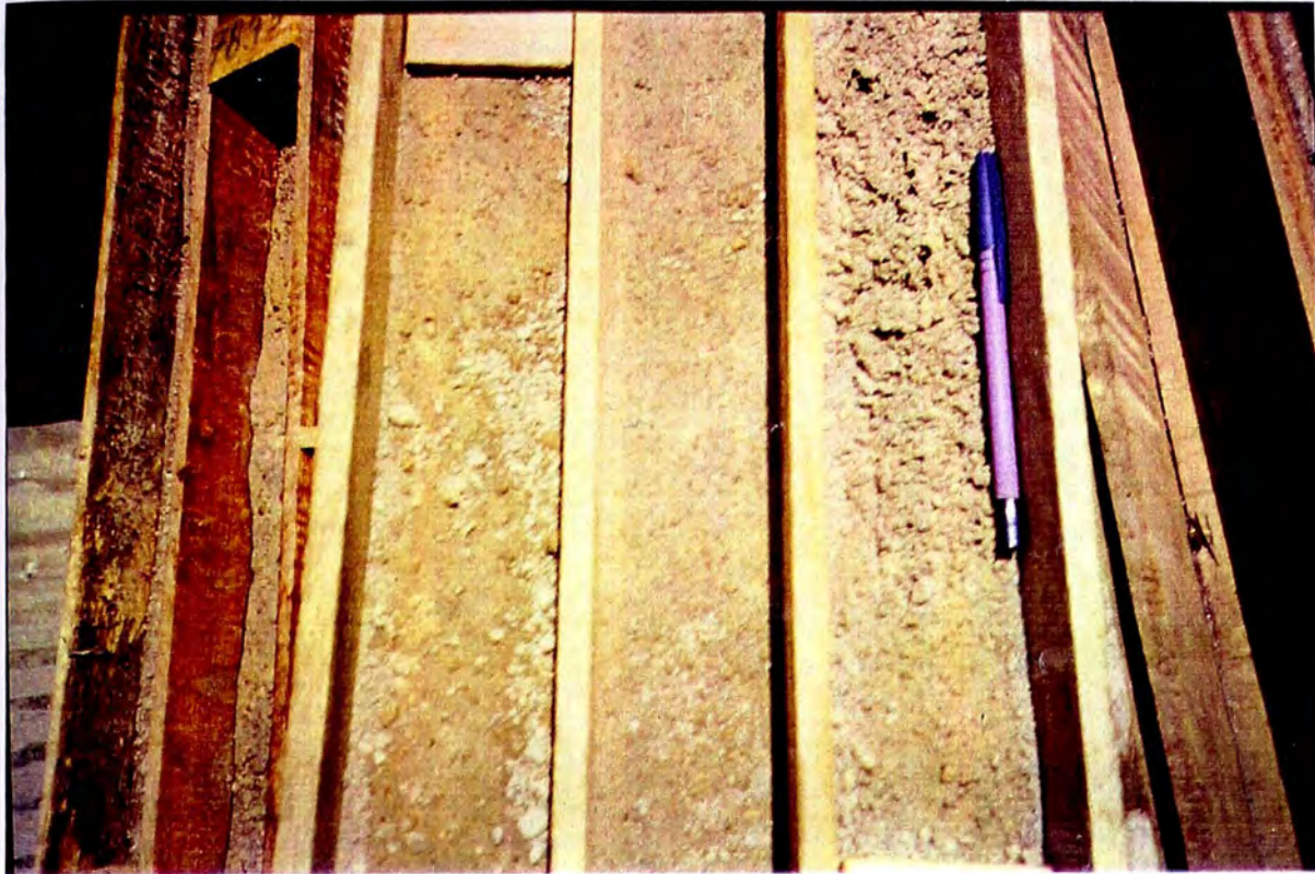
CAJA DE PERFORACION DIAMANTINA CON ROCA TIPO 1
