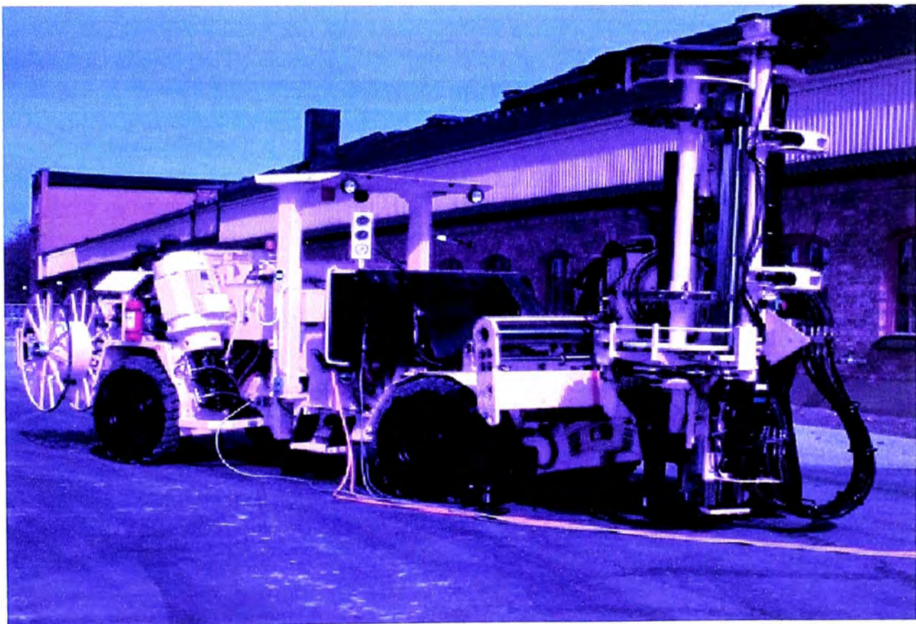
FIGURA N° 14: EQUIPO DE PERFORACIÓN SIMBA H-1354
