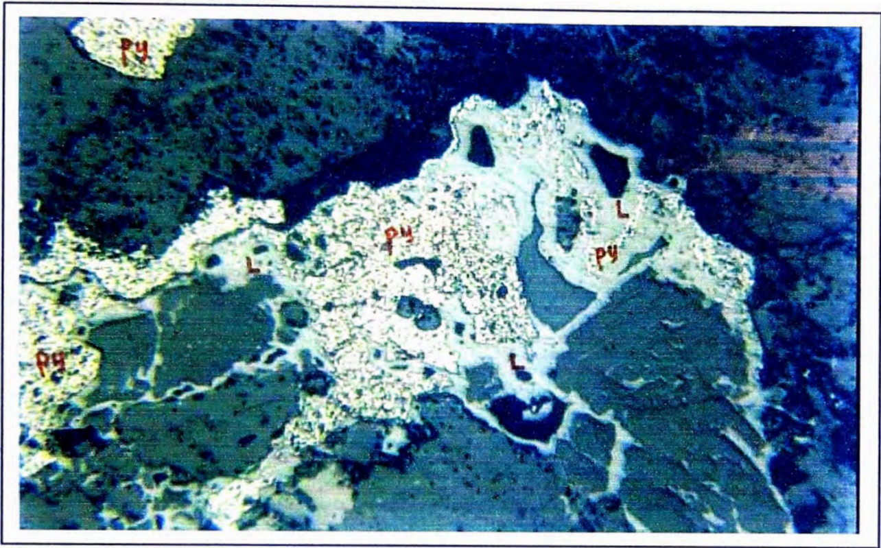
200 \mu\text{m} FOTO 7: C-5 (R.C. T-Sur, Nv 220). Sección pulida, nicoles paralelos. Playa de pirita (py) parcialmente limonitizadas (L).
