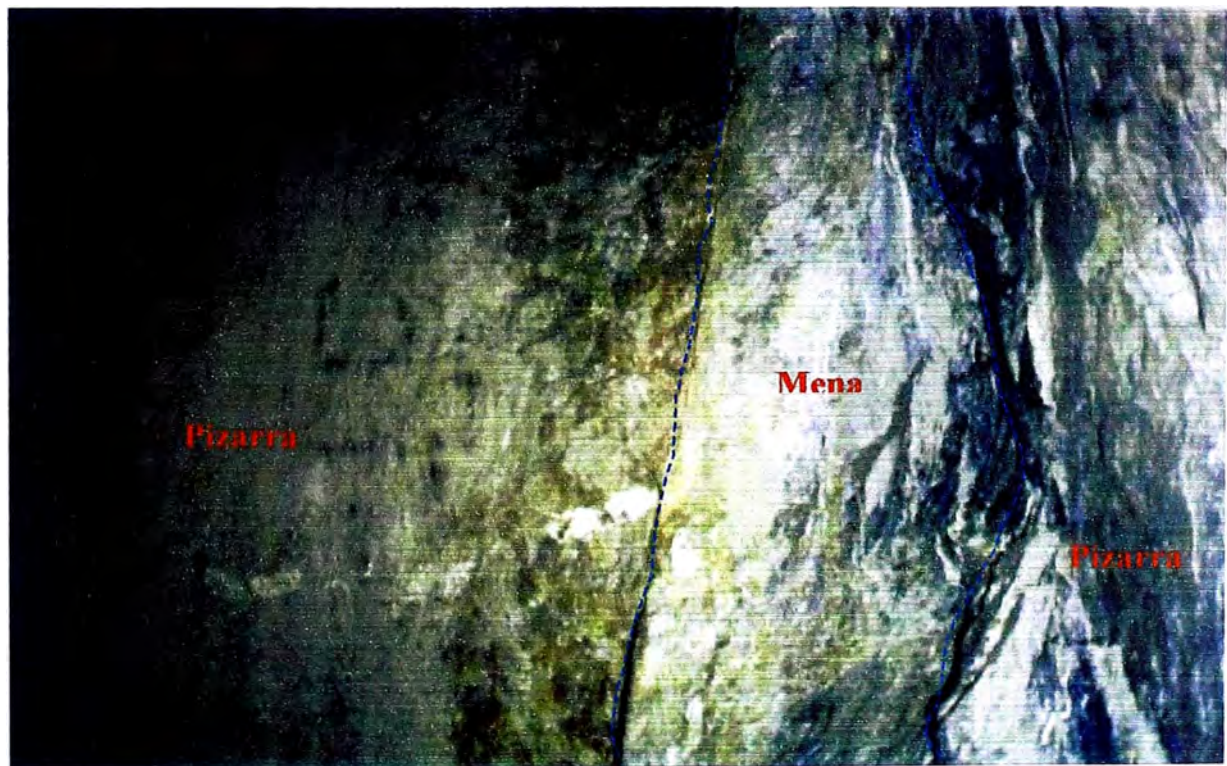
FOTO N°6 Estructura mineralizada de 0.60 m de potencia con contacto entre pizarras, además observamos un pequeño fallamiento sin desplazamiento. (Nv 220 R.C.)
