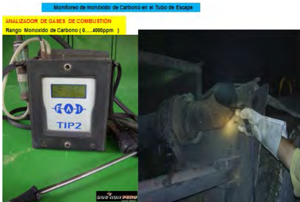
Figura 4.2: Monitoreo de monóxido de carbono en el tubo de escape.
