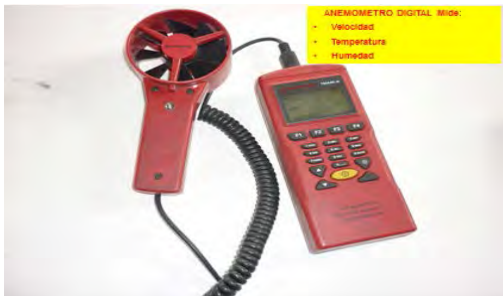
Figura 4.3: Equipo de Monitoreo de Velocidades, Temperatura y Humedad.
