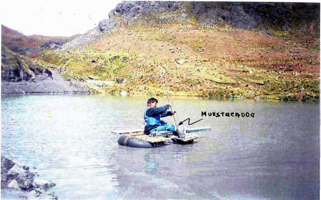
Fotografía N° 9 - Extracción de muestras en la zona de lamas. Estanque de Finos
