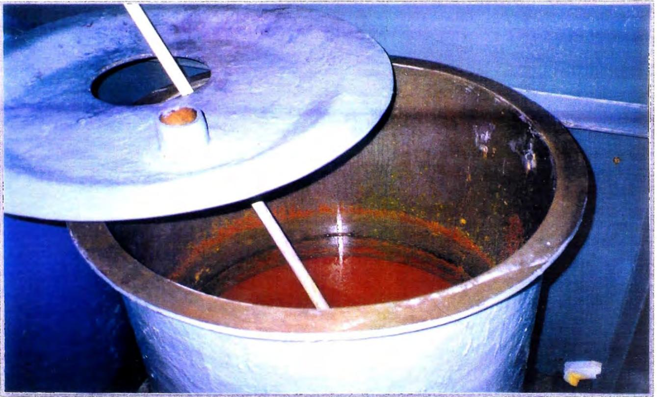
FOTO N°4.- PRECIPITADOR VESSEL
