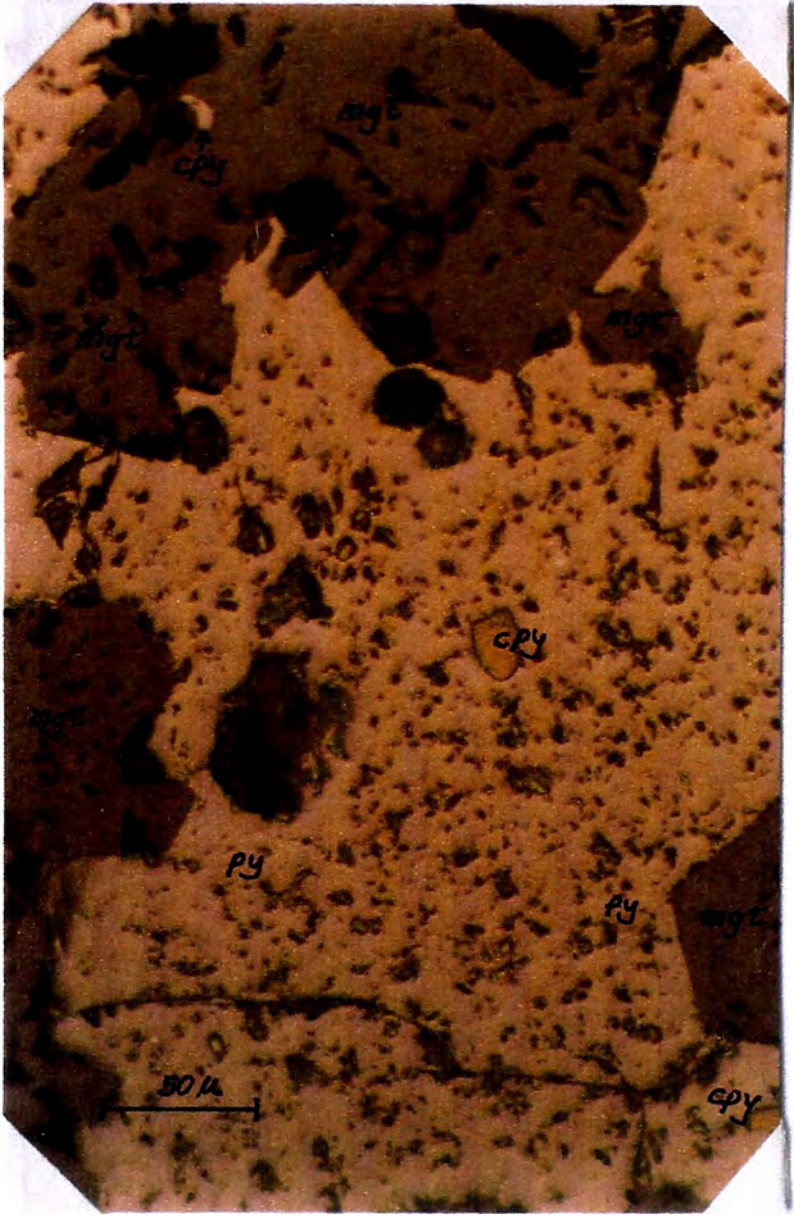
Calcopirita en porosidades de magnetita y pirita . Magnetitas en cristales euhedrales.
