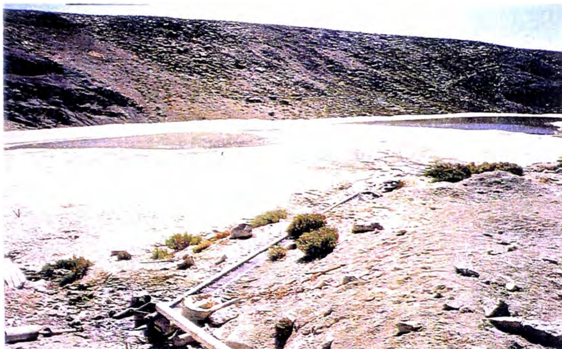
Descarga del exceso de agua, del filtro y del espesador hacia la cancha de relave No. 1
