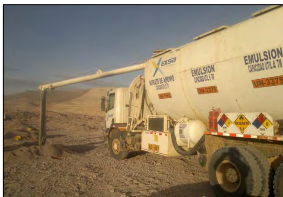
Figura N° 6.4: Muestra el carguío de un taladro con Heavy ANFO en Cuajone.
