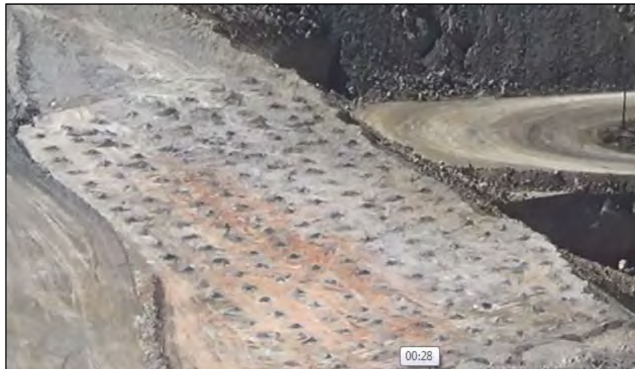
Figura N° 4.1: Muestra el diseño de malla in situ (Fuente Mina Cuajone).
