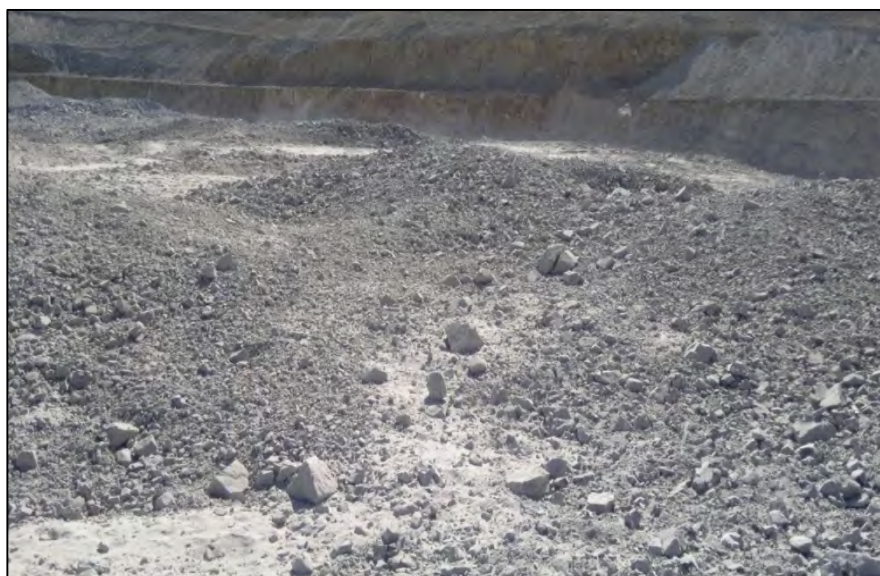
Figura N° 7.10: Muestra la zona A con taladros secos y con espaciamiento de 8 m.
