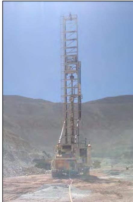
Figura N° 3.3: Muestra la perforación rotativa en minería superficial, (Fuente Mina Cuajone).
