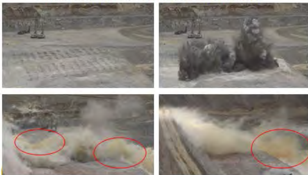
Figura N°6.15: Muestra la presencia de gases anaranjados (Fuente Mina Cuajone).
