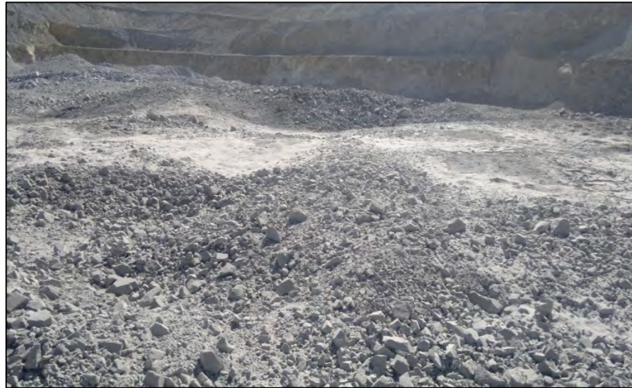
Figura N° 4.4: Muestra la fragmentación como resultado de la voladura en Cuajone.
