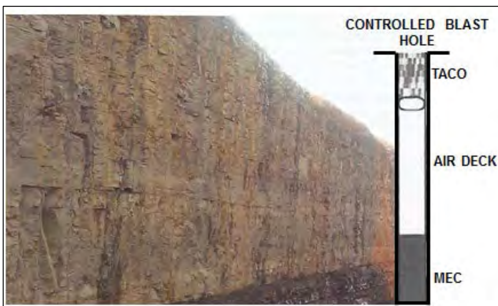
Figura N° 4.10: Muestra los resultados usando voladura controlada, (Fuente ISEE).
