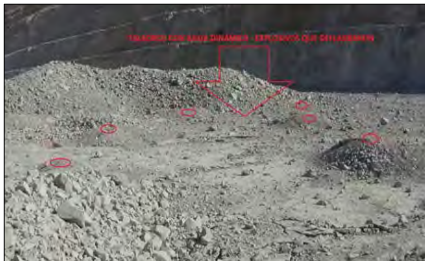
Figura N° 7.9: Muestra la Zona B con taladros con agua dinámica.
