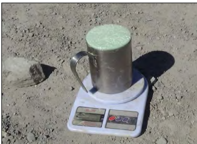
Figura 7,21 Muestra la realización de la prueba de densidades
