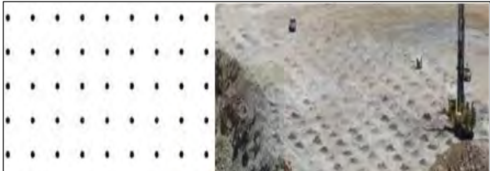
Figura N° 4.6: Muestra el diseño de malla B x S en Cuajone.
