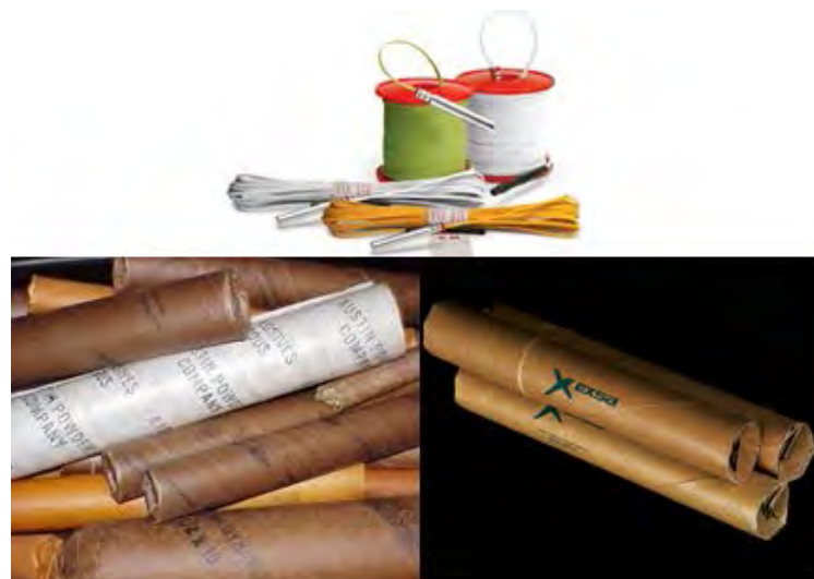
Figura N° 3.6: Muestra un alto explosivo dinamita, (Fuente web internet y Exsa).
