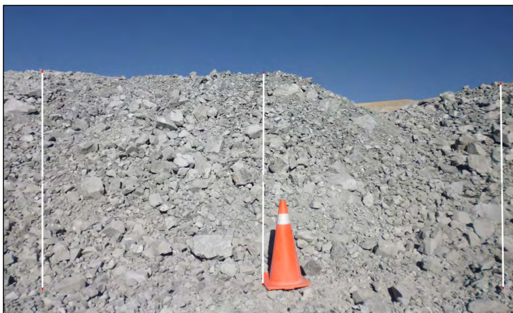
Figura N° 7.20 (a): Muestra el esponjamiento del material fragmentado
