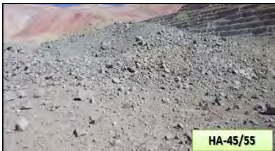
Figura N° 7,37 Muestra el material volado en la zona cargada con HA – 45/55
