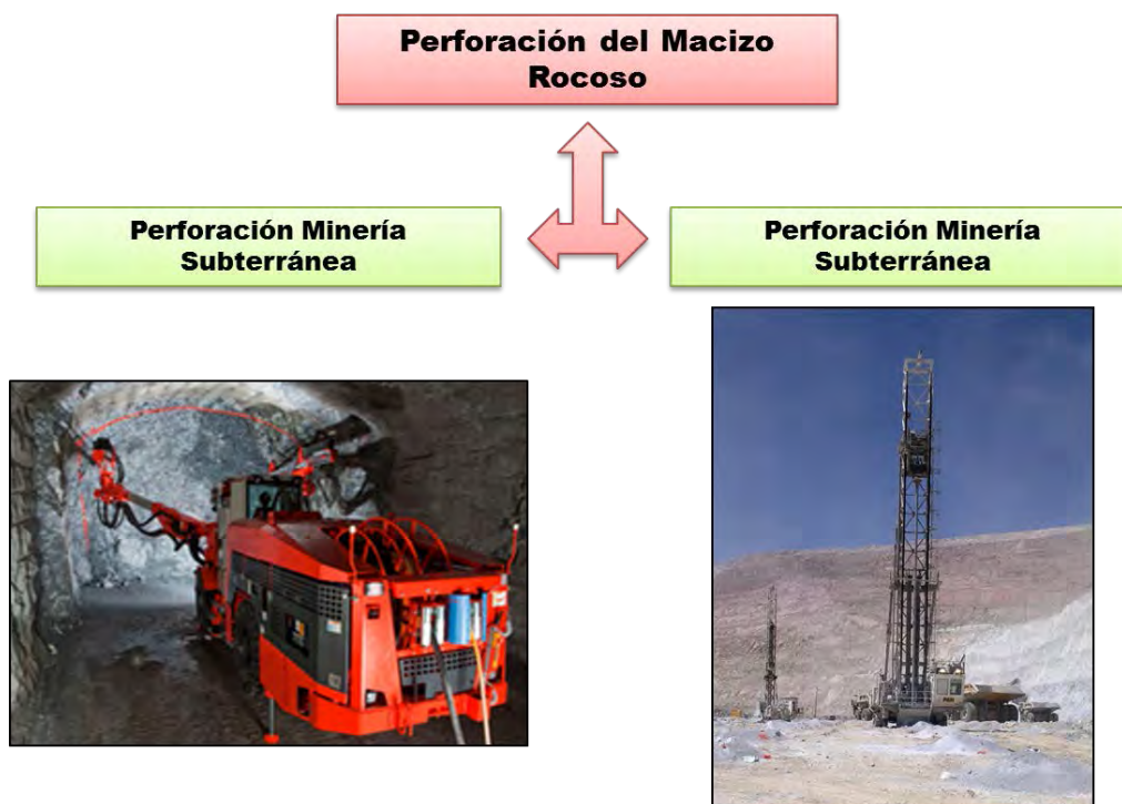
Figura 3.2: Muestra la perforación subterránea Vs. La perforación superficial (Fuente: Roberto O. Medina Cortez).
