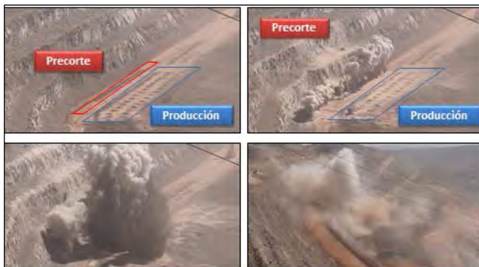
Figura N° 4.11: Muestra una voladura de producción y pre corte para proteger la roca remanente.
