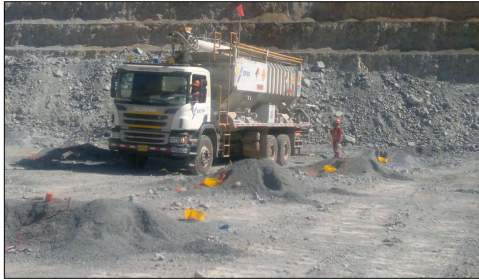
Figura N° 6.1: Muestra el camión fábrica cargando los taladros del pit en Mina Cuajone.
