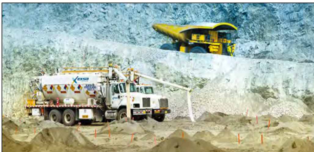
Figura N° 6.12: Muestra el carguío de los taladros en open pit, (Fuente web Exsa).
