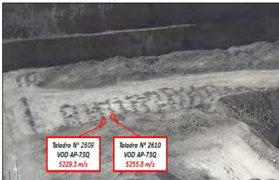
Figura N° 7.12: Muestra la VOD de los taladros cargados con AP-73Q
