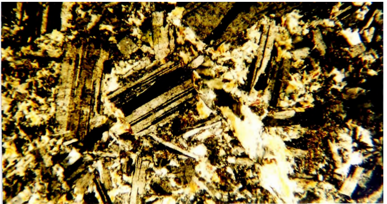
MICROFOTOGRAFIA N° 4 (M-1): Fenocristales subhedrales y anhedrales de plagioclasas cortados por venillas de clorita y cuarzo, rodeados por una matriz microlítica Magnificación 6.3X
