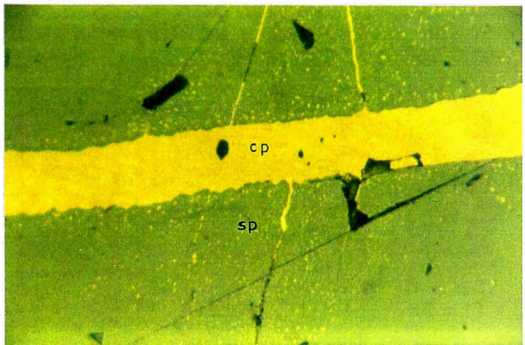
MICROFOTOGRAFIA No 2: Esfalerita masiva con una veni-lla de calcopirita que la corta. Ademas calcopirita diseminada segùn el clivaje.
