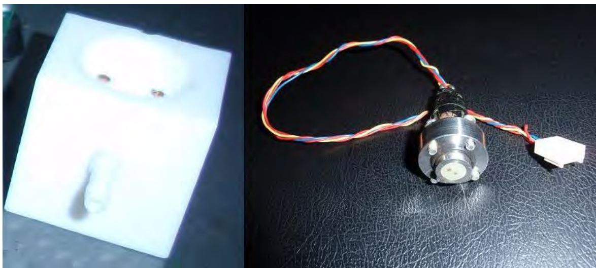
Figura 4-1 : (Izquierda) Cámara de Teflón, se puede observar el conducto por donde se evacuará el pisco luego del censado. (Derecha) Contra-electrodo y electrodos de trabajo soldados a un conector MOLEX-4PIN.
