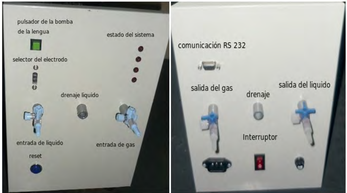
Figura 4-27 : Vistas frontales del prototipo realizado y las funciones de sus periféricos.
