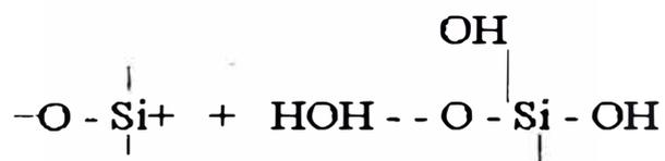
Cuando la tensión de vapor crece, la capa hidrofílica se cubre, según su vapor, de una capa más o menos completa de moléculas de agua, llamada "agua residual", retenida sobre la superficie por unas fuerzas más energéticas que las de Van der Waals.
